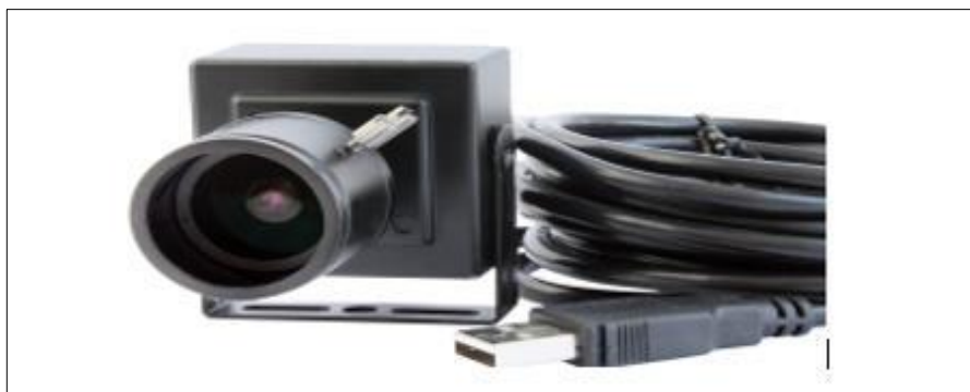
Figura 3-3: Cámara ELP modelo ELP-USBFHD06H-BFV
