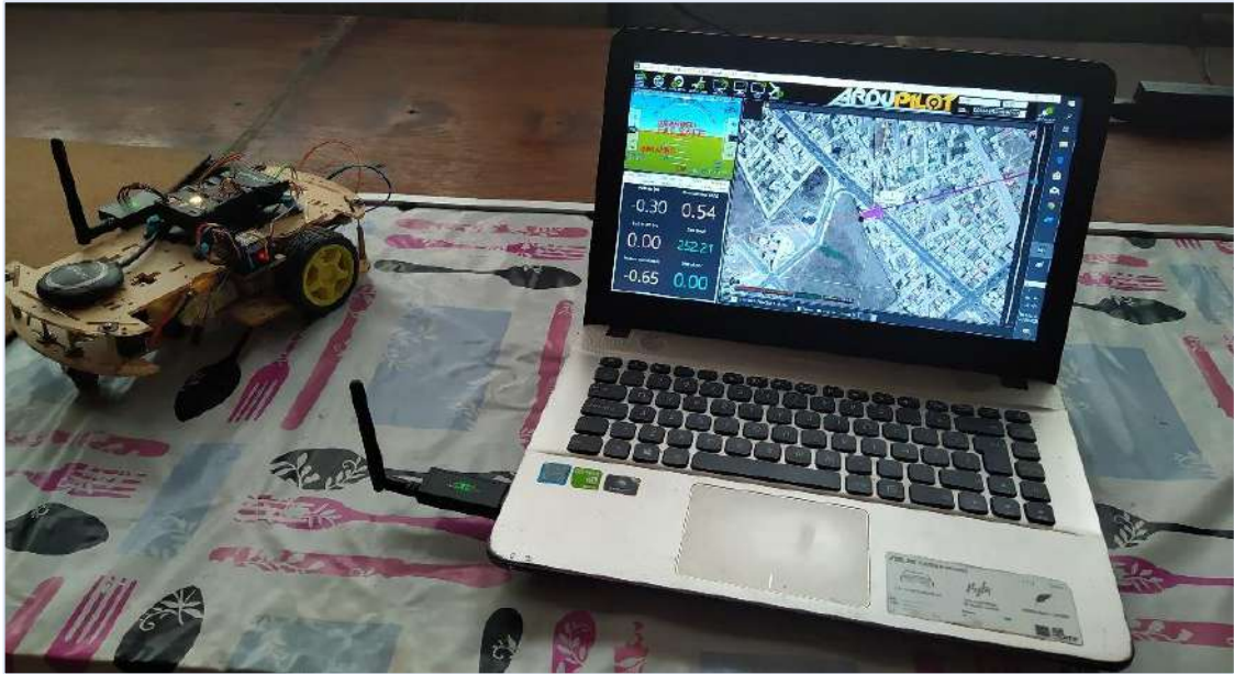
Figura 12-3: Implementación del Sistema de Posicionamiento INS/GPS
