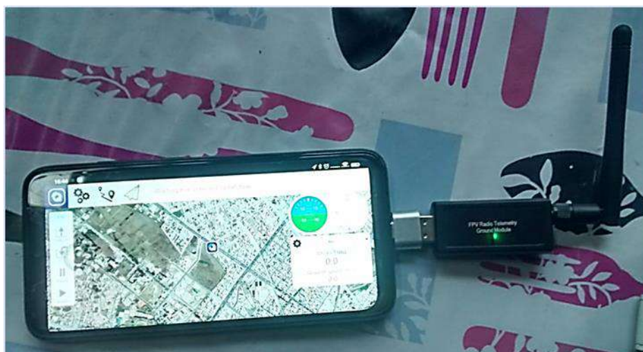
Figura 11-3: Estación Base Celular
