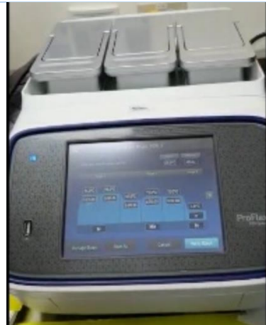
Calibración del Termociclador Applied Biosystems™ Sistema de PCR ProFlex™, 3 x 32 pocillos
