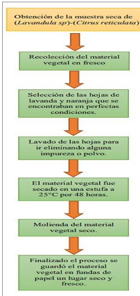
**Ilustración 2-2:** Diagrama de obtención de la muestra seca
