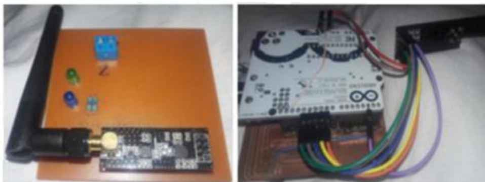
Figura 17-1. Conexión del módulo NRF24L01 con Arduino Uno y Mega.
