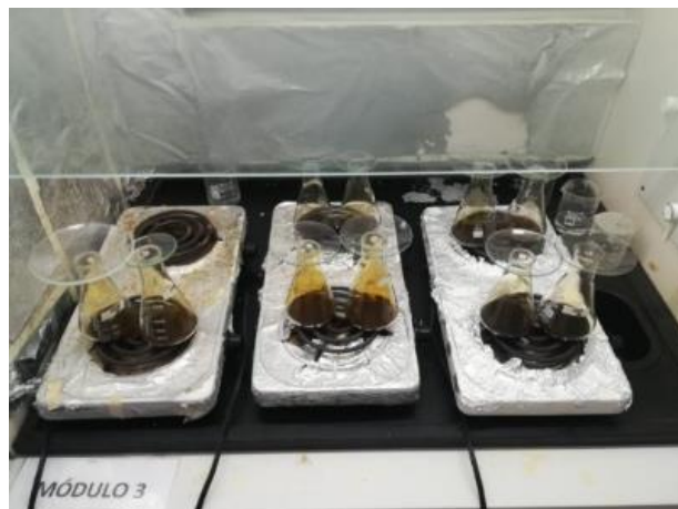
Ilustración 13-3: Digestión de muestras de suelo
