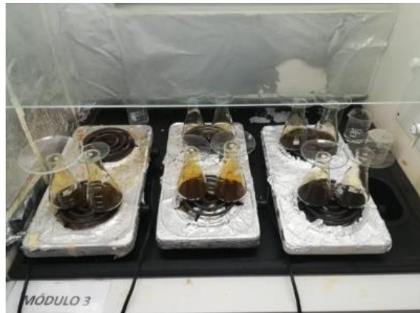
Ilustración 15-3: Digestión de muestras de suelo
