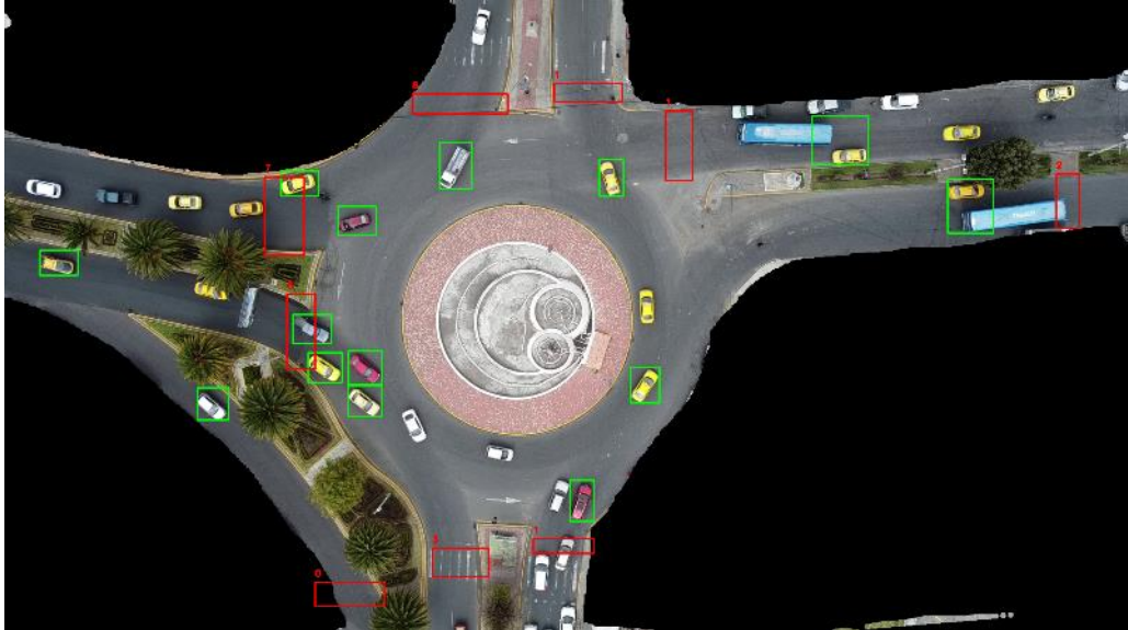
Figura 21-4. Detección y conteo vehicular - Av. La Prensa y Av. Daniel León Borja Fuente: Software de autor
