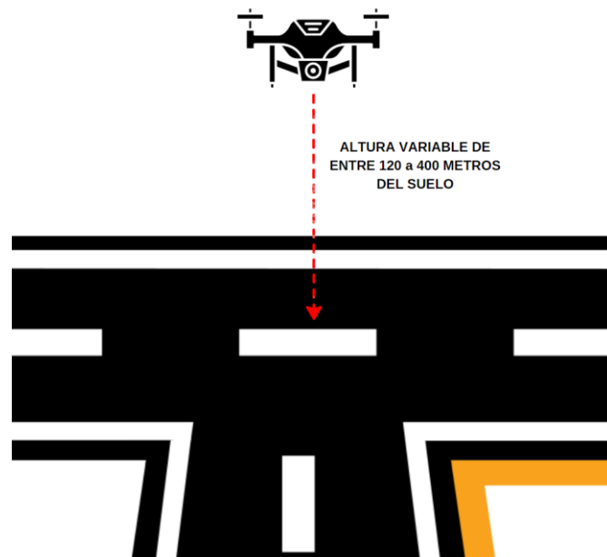
Figura 10-5. Altura recomendada en intersecciones complejas
