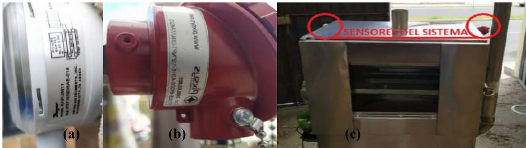
Figura 24-3: (a)Sensor de humedad;(b)Sensor de temperatura;(c)Implementacion del sensor Realizado por: CUEVA, Cristian, 2020.
