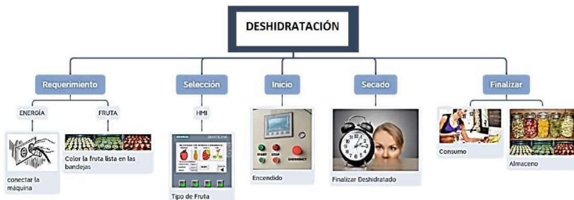
Figura 3-4: Funcionamiento del deshidratador Realizado por: CUEVA, Cristian, 2020.
