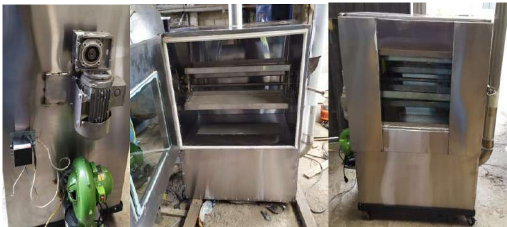
Figura 1-4: Mecánica del deshidratador, quemador, motor, bandejas, base con ruedas
