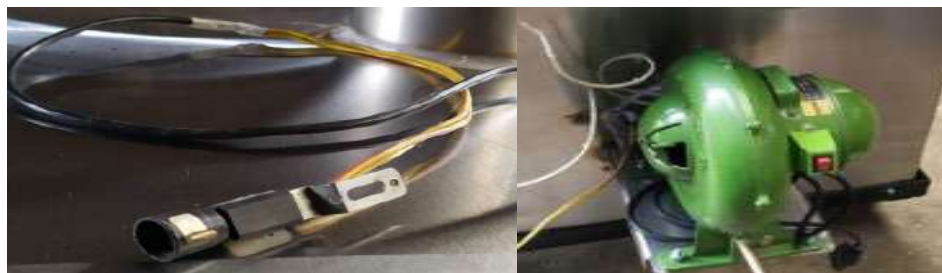
Figura 32-3: Sistema de Control de temperatura con termocupla en el quemador. Realizado por: CUEVA, Cristian, 2020.
