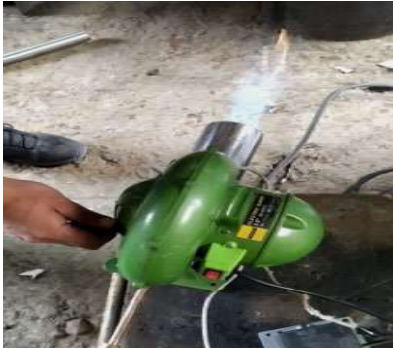
Figura 16-3: Quemador industrial implementado y control de flama Realizado por: CUEVA, Cristian, 2020.
