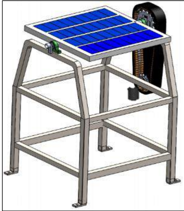
Figura 35-3. Soporte panel y sistema de engranajes Realizado por: Yépez, J.; Girón, A. 2020.
