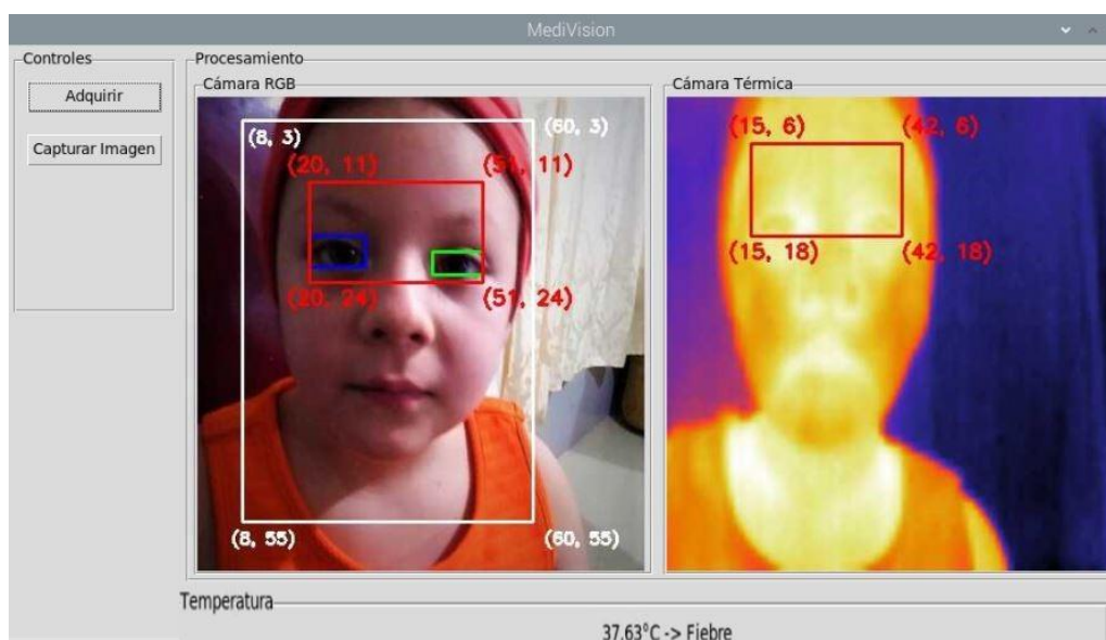
Figura 3-4: Funcionamiento del dispositivo electrónico de temperatura infrarrojo.
