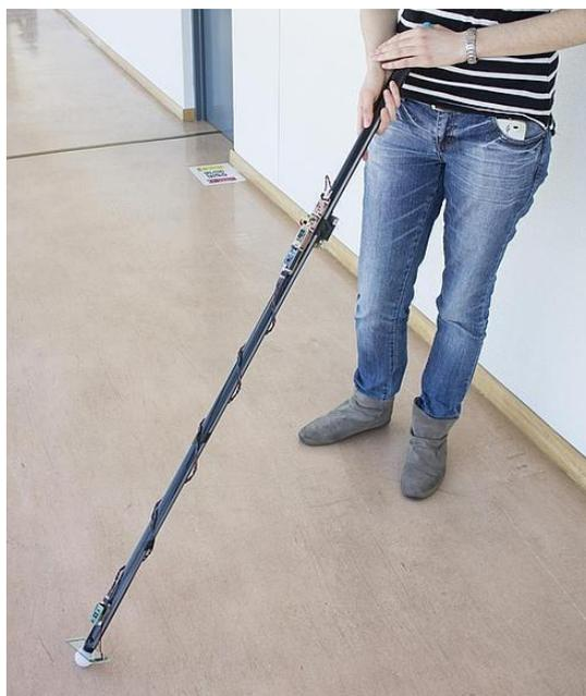
**Figura 3-1:** Bastón electrónico.
