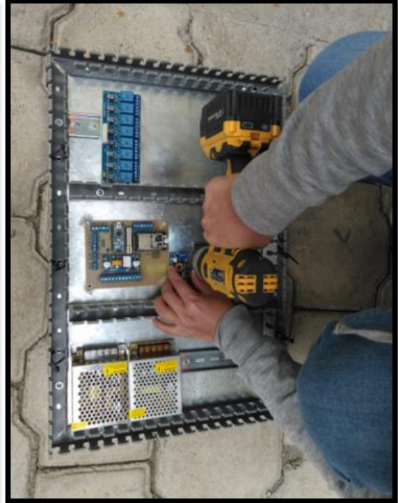
b. Ensamble de rieldín y borneras.
