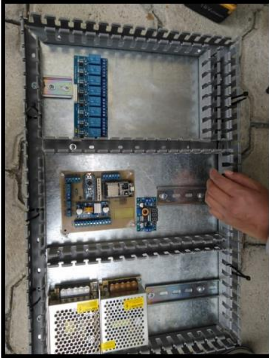
a. Ensamble de fuente de poder y relé.
