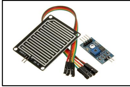
Figura 16-2. Sensor de Lluvia FC-27 Fuente: (Datasheet FC-27, 2020)
