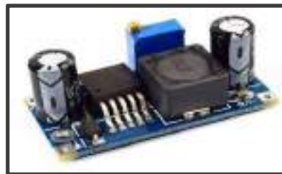
Figura 8-3: Fuente Step Down LM2596
