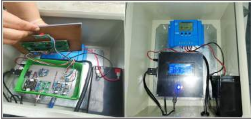
Figura 6-4: Nodo de adquisición parte interna del nodo parte externa
