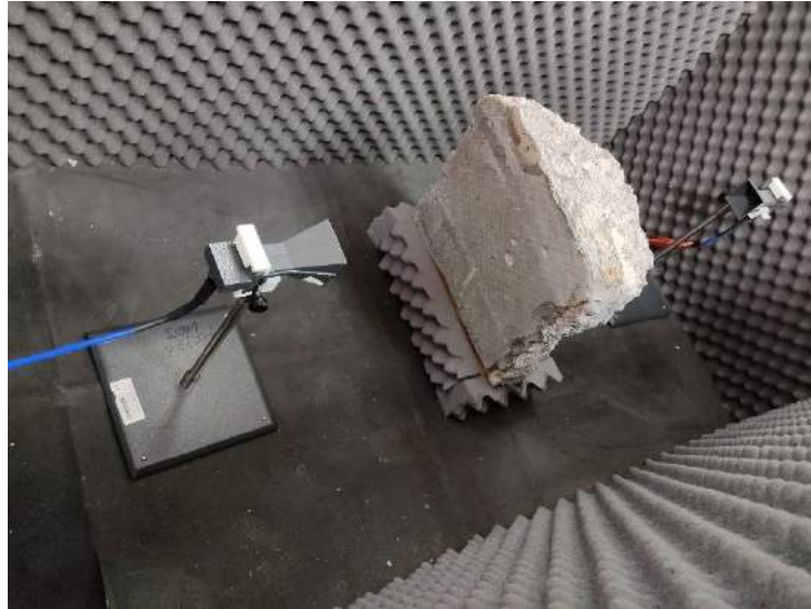
Figura 15-2. Pérdidas de propagación dentro de cámara anecoica con pared
