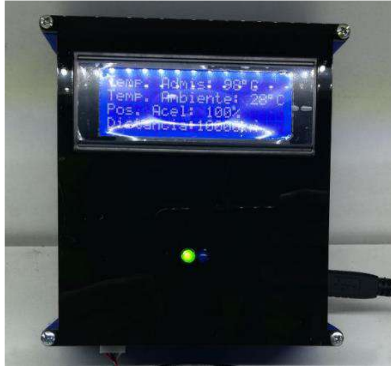
Figura 23-2: Leds indicadores Realizado por: Montesdeoca, Andrea, 2020
