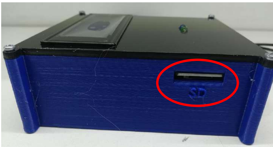
Figura 26-2: Ranura para micro SD Realizado por: Montesdeoca, Andrea, 2020
