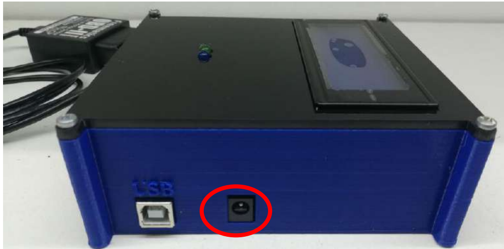
Figura 25-2: Puerto de alimentación en el prototipo Realizado por: Montesdeoca, Andrea, 2020
