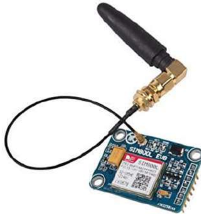
Figura 21-1: Módulo GSM 1800L Fuente: (AMAZON, 2018)
