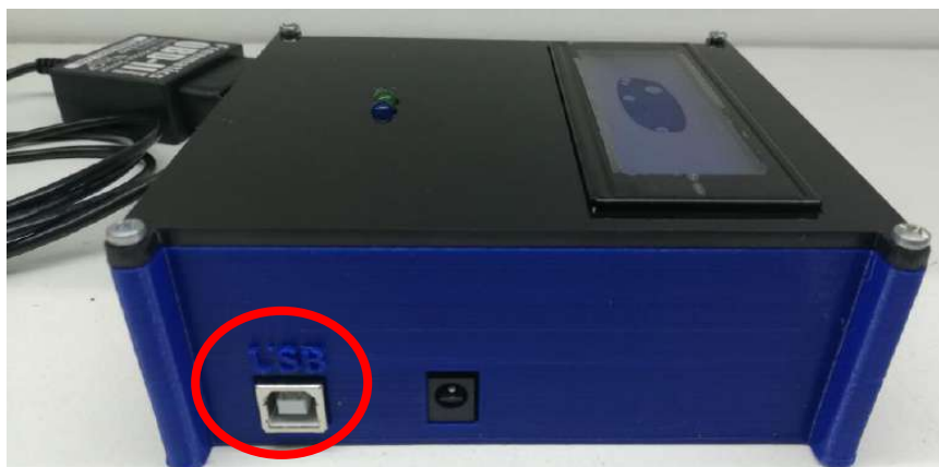
Figura 24-2: Puerto USB de programación Arduino Realizado por: Montesdeoca, Andrea, 2020
