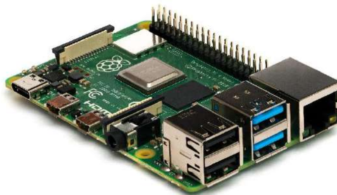
Figura 15-1: Tarjeta de desarrollo Raspberry Pi
