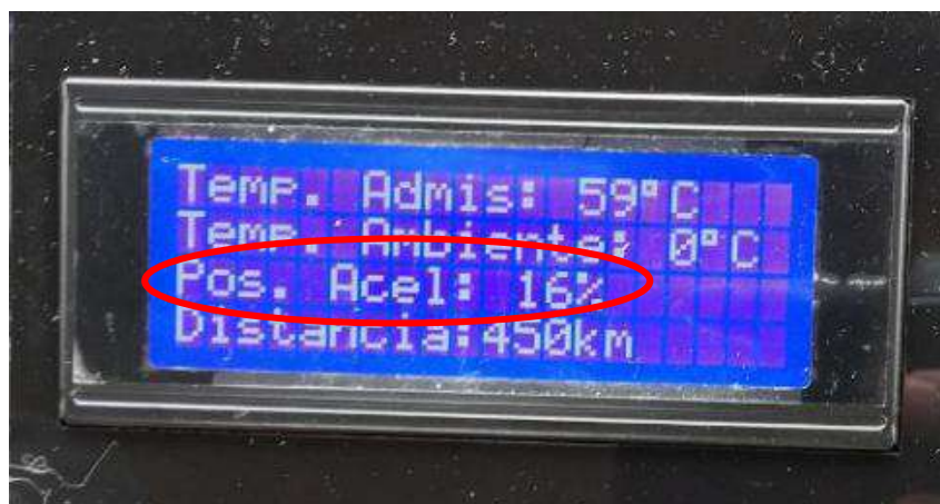
Figura 17-3: Visualización del dato en el sensor posición acelerado Realizado por: Montesdeoca, Andrea, 2020
