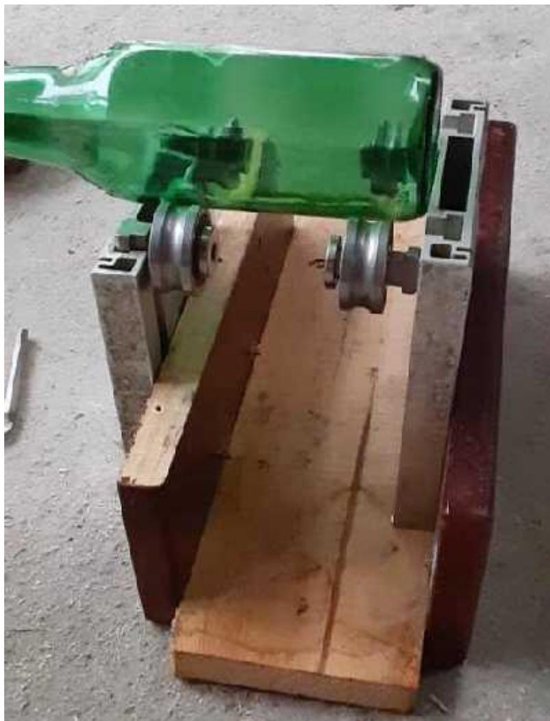
**Ilustración 26-4:** Cortadora de vidrio (manual casera)
