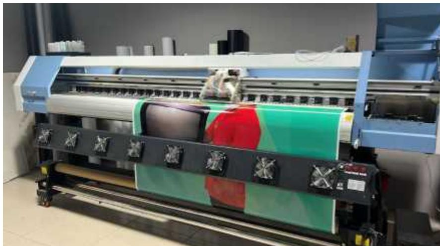
**Ilustración 32-4:** Plotter de Impresión
