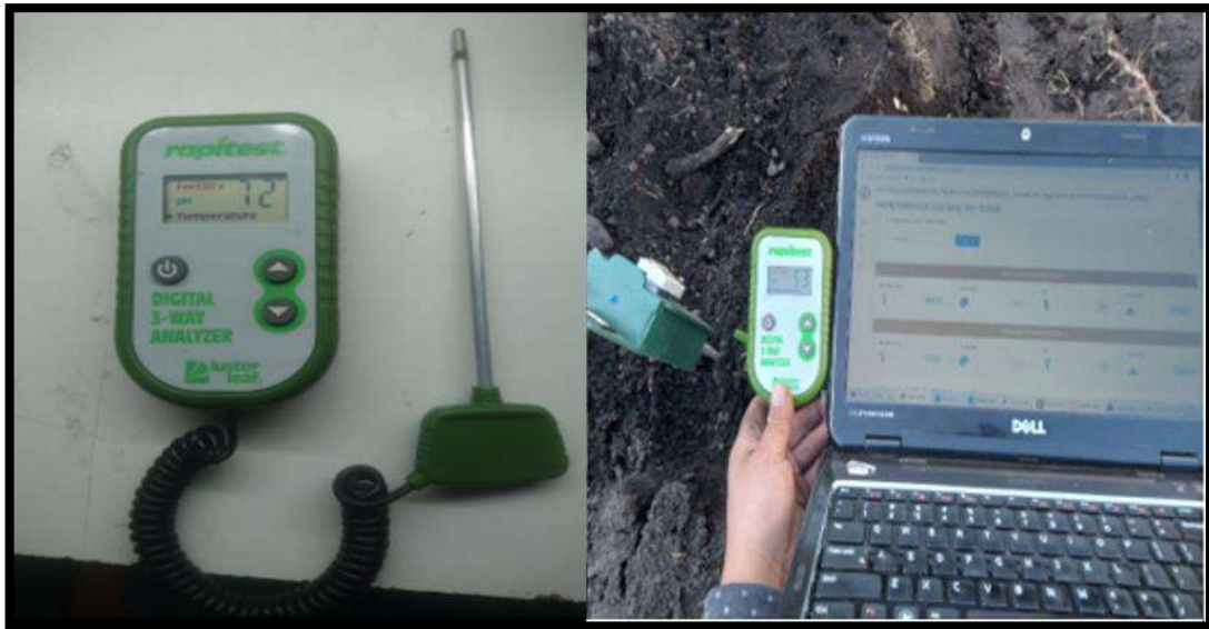
Figura 4-3: Rapitest (izquierda), nodos sensores y rapitest (derecha).
