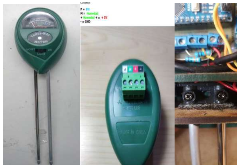
Figura 9-2: Sensor de suelo 3 en 1 (Humedad, pH, Luz).
