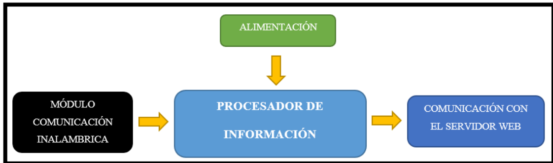
Figura 4-2: Bloques del módulo receptor.
