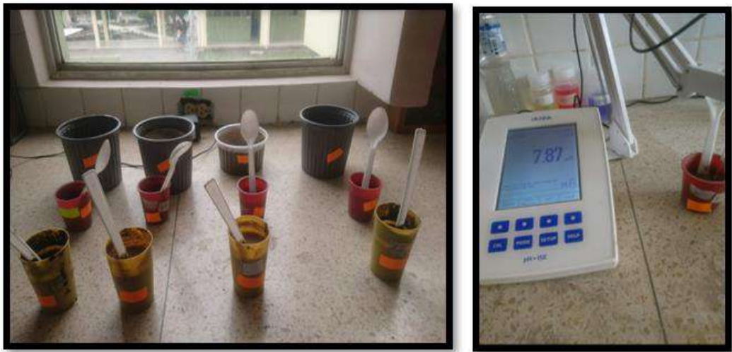
Figura 6-3: Muestras de terreno (izquierda), medición de terreno en el pH-metro (derecha).
