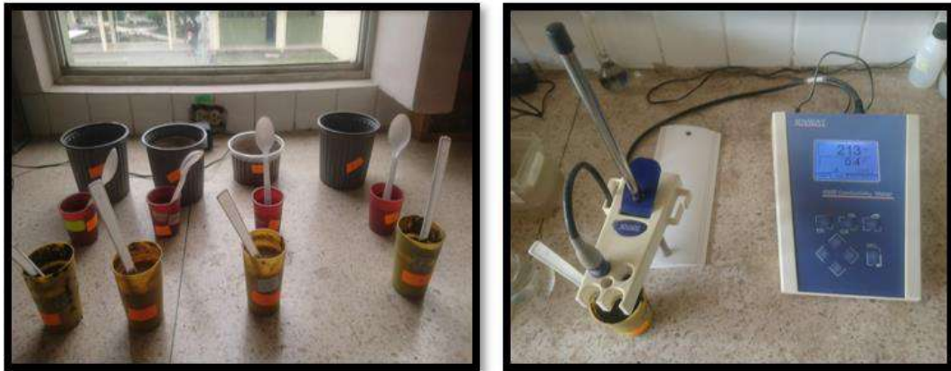
Figura 7-3: Muestras de terreno (izquierda), terreno medido en el conductímetro (derecha).
