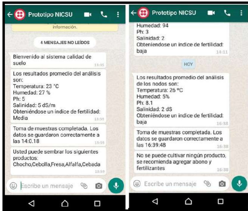
Figura 19-3: Ejemplo de mensaje con fertilidad media (izquierda) y fertilidad baja (derecha).
