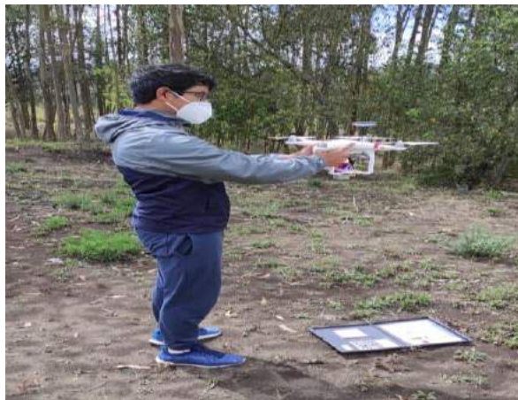
Figura 6-3: Calibración de reflectancia Realizado por: Chávez, Jhony; 2020
