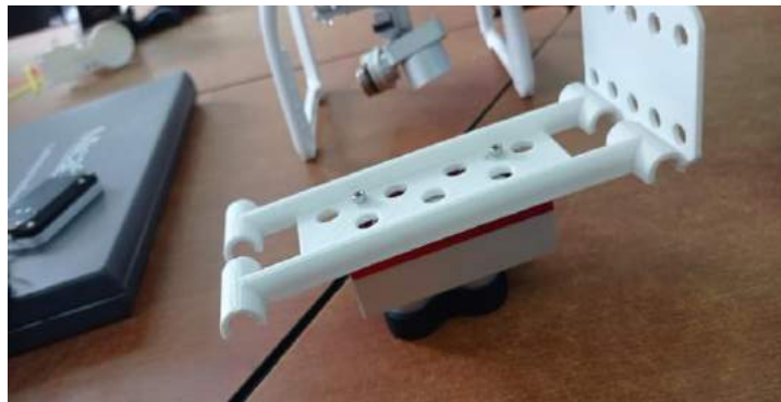
Figura 3-3: Montaje de la cámara Micasense Redegde al acople 3D Realizado por: Chávez, Jhony; 2020
