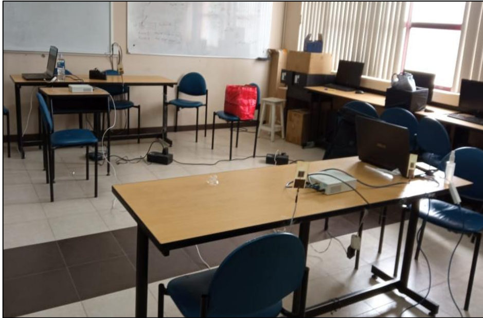
Figura 46-3: Escenario SIMO polarización vertical a 4 m.
