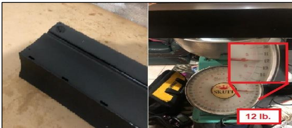
Figura 36-3. Evidencia del objeto con el que se desarrolló la prueba y su peso de 12 lb.
