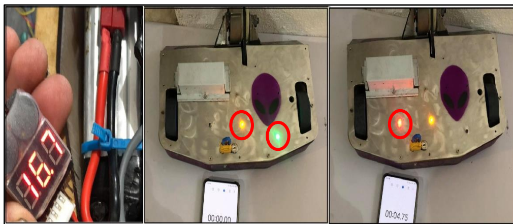
Figura 38-3. Desarrollo de la prueba del Sistema de Protección con la batería 2 a plena carga.
