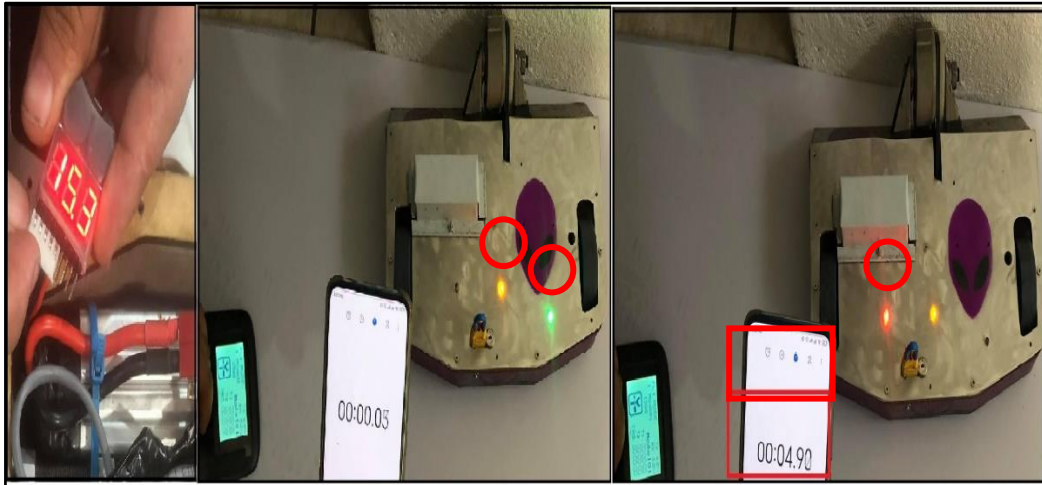
Figura 39-3. Desarrollo de la prueba del Sistema de Protección con la batería 2 a media carga.
