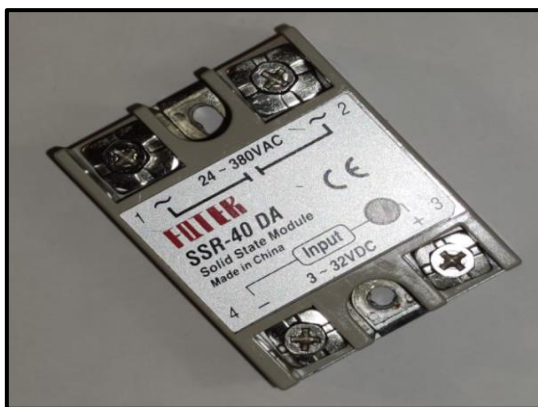
Figura 14-2. Relé de estado sólido FOTEK 40 DA.
