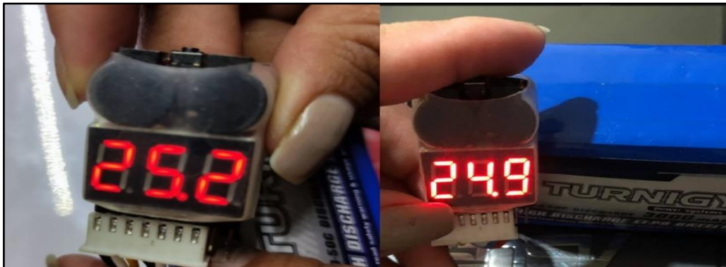
Figura 34-3. Mediciones de consumo en la batería 1 con el DIR12GMP en funcionamiento.
