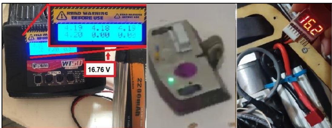
Figura 33-3. Mediciones de consumo en la batería 2 con el DIR12GMP en funcionamiento.
