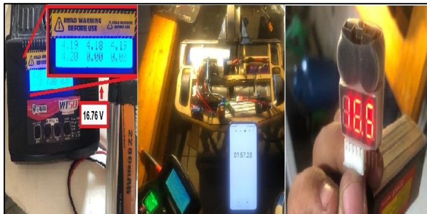
Figura 32-3. Mediciones de consumo en la batería 2 con el DIR12GMP embancado.
