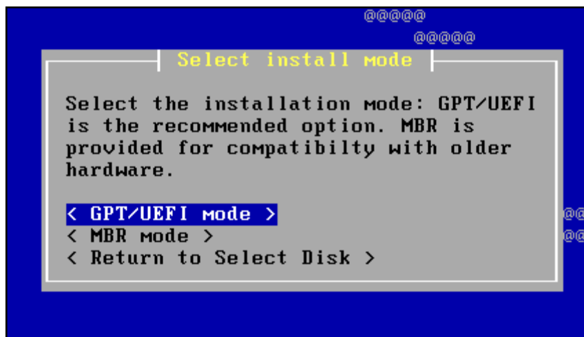
Figura 11-2: Modos de instalación
