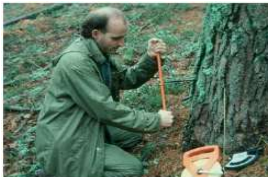
Figura 5-2: Proceso de medición con barrena. Fuente: (Diéguez, 2005).
