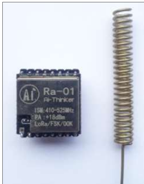
Figura 30-3: Módulo Lora SX1278. Realizado por: Cuenca, G. & Valdivieso, C. 2020
