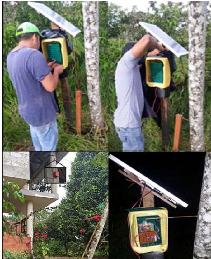
Figura 13-4: Implementación del prototipo (arriba) y prototipo en funcionamiento (abajo) Realizado por: Cuenca, G. & Valdivieso, C. 2020.
