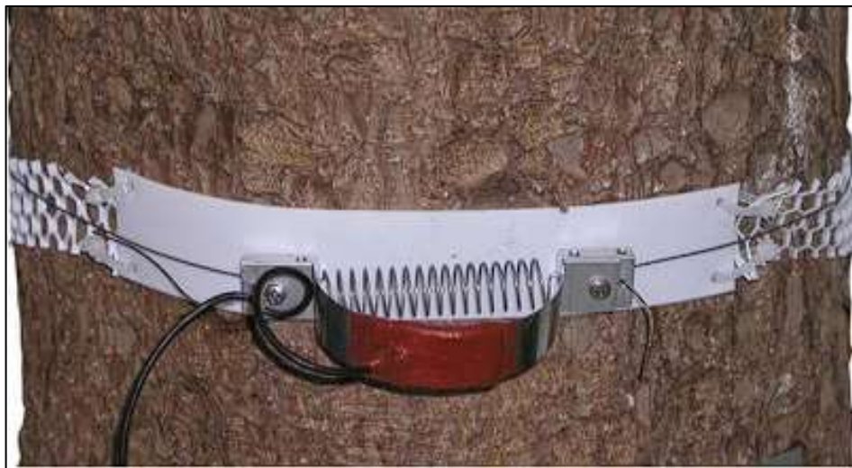
Figura 15-2: Dendrómetro perimetral con galga extensiométrica.
