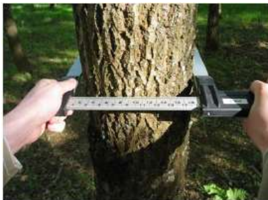
Figura 3-2: Medición con forcípula. Fuente: (Diéguez, 2005).
