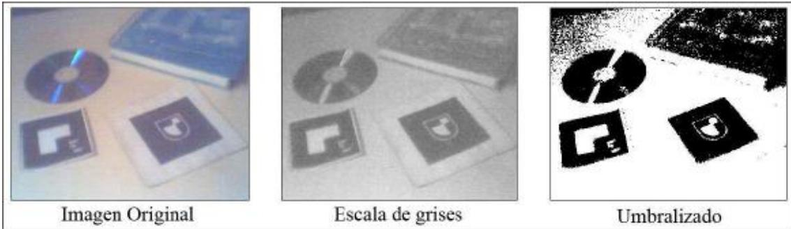
Figura III.18: La imagen original se convierte primero a escala de grises y luego se umbraliza.
