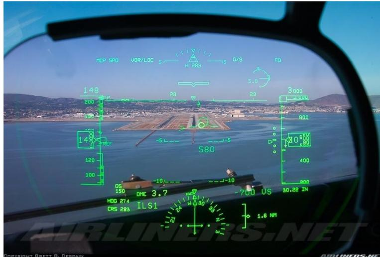
Figura III. 03: Ejemplo de uso de realidad aumentada en la cabina de un avión
