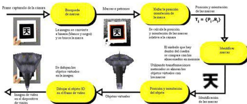
Figura III.13: Pasos del algoritmo de posicionamiento usando ARToolkit
