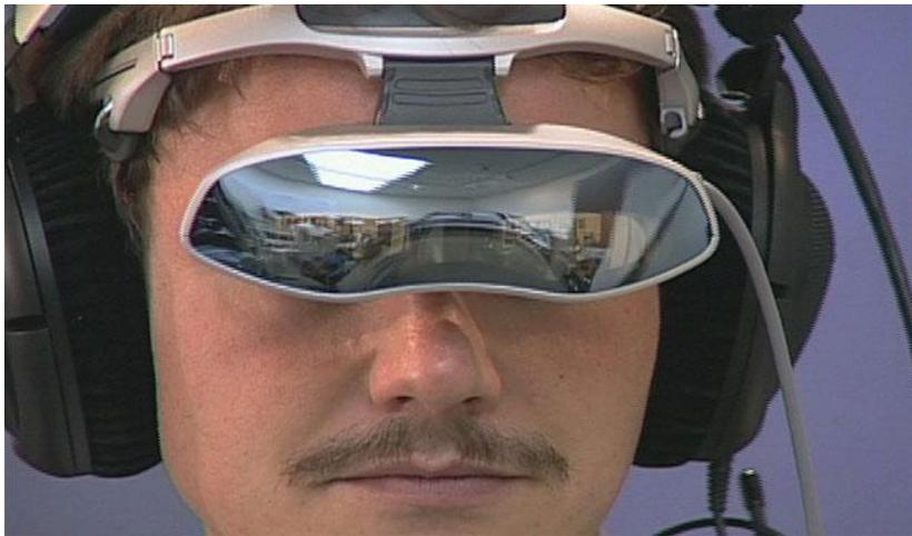
Figura III. 02: Ejemplo .Casco de visualización (*Head-MountedDisplay*, HMD)
