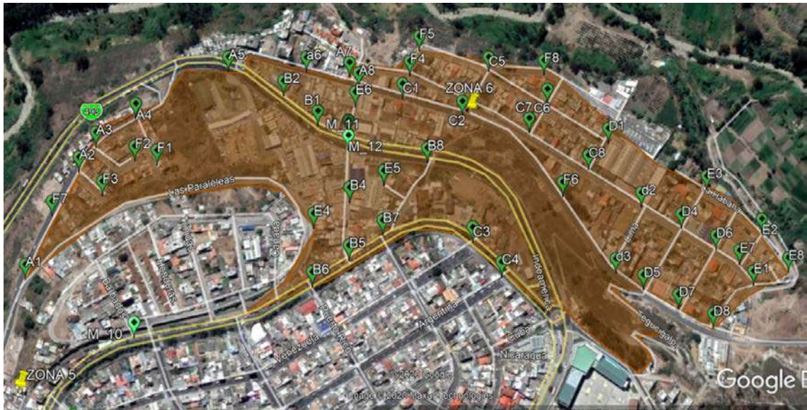
Figura 29-3. Cajas de distribución ópticas para la M_11 y M_12
