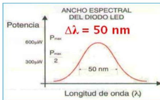
Figura 6-2. Ancho espectral del diodo LED.
