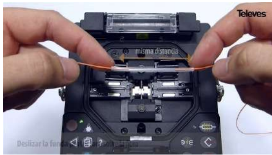
Figura 10-2. Empalme por fusión.
