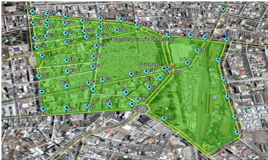
Figura 21-3. Cajas de distribución ópticas para la M_05 y M_06 Realizado por: Mayorga, Sebastián, 2020
