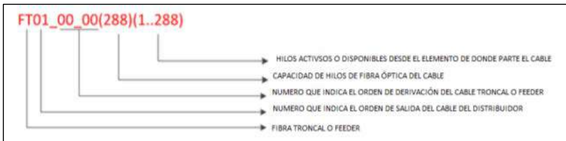
Figura 7-3. Identificador de la red Feeder
