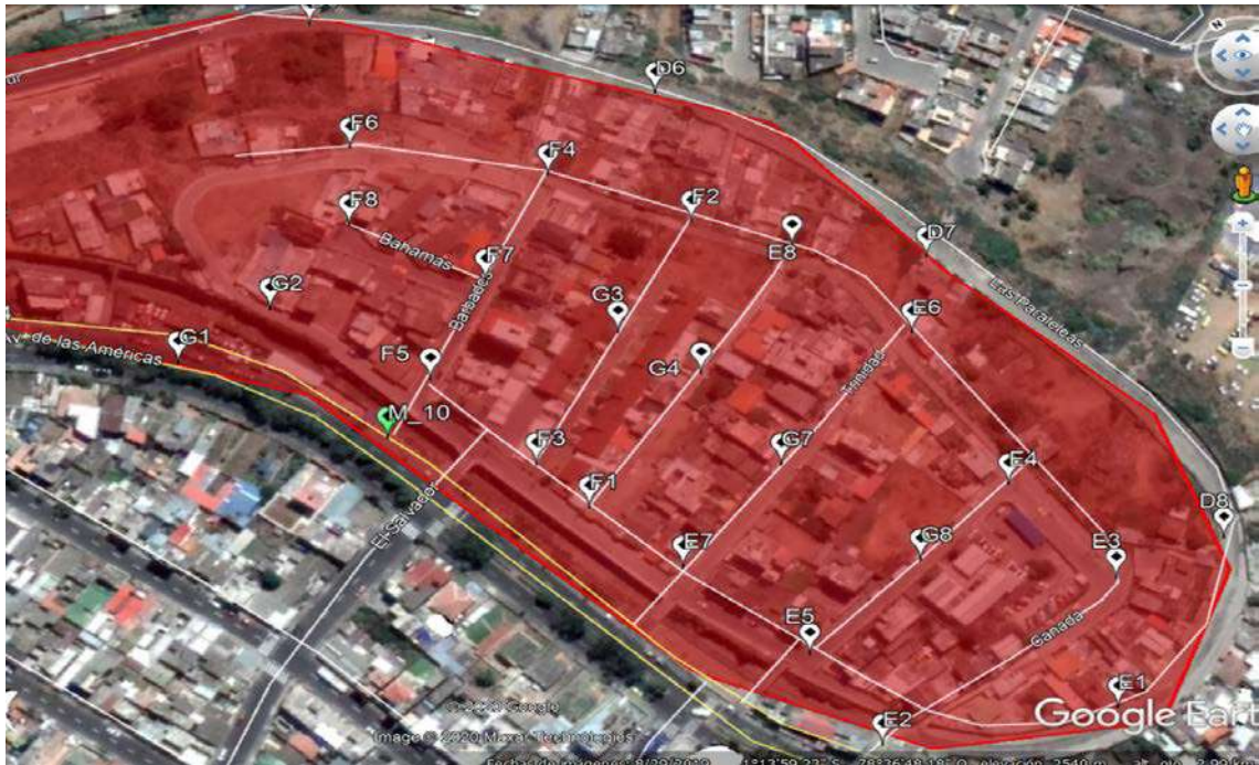
Figura 26-3. Cajas de distribución ópticas para la M_10
