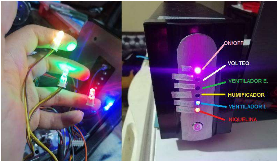
Figura 10-2: Distribución de colores de leds pilotos. Realizado por: Yerovi, Guillermo; 2020.
