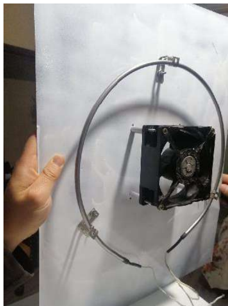
Figura 15-2: Ventilador Anclado a la lata de soporte
