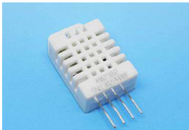
Figura 5-1: Sensor de Temperatura y Humedad DHT22
