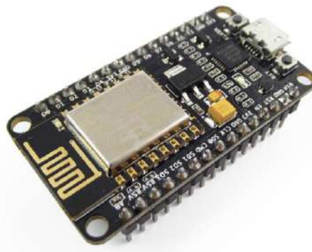
Figura 11-1: Placa Wi-Fi NodeMCU ESP8266
