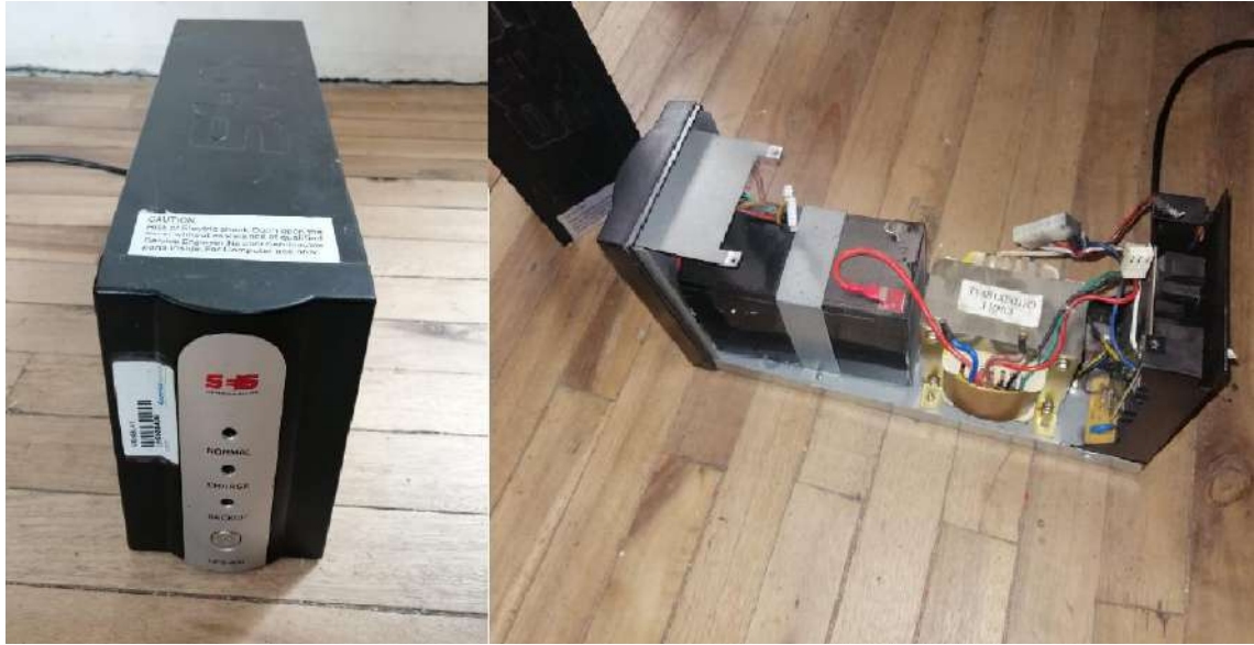
Figura 7-2: Parte Exterior e interior de UPS en desuso. Realizado por: Yerovi, Guillermo; 2020.
