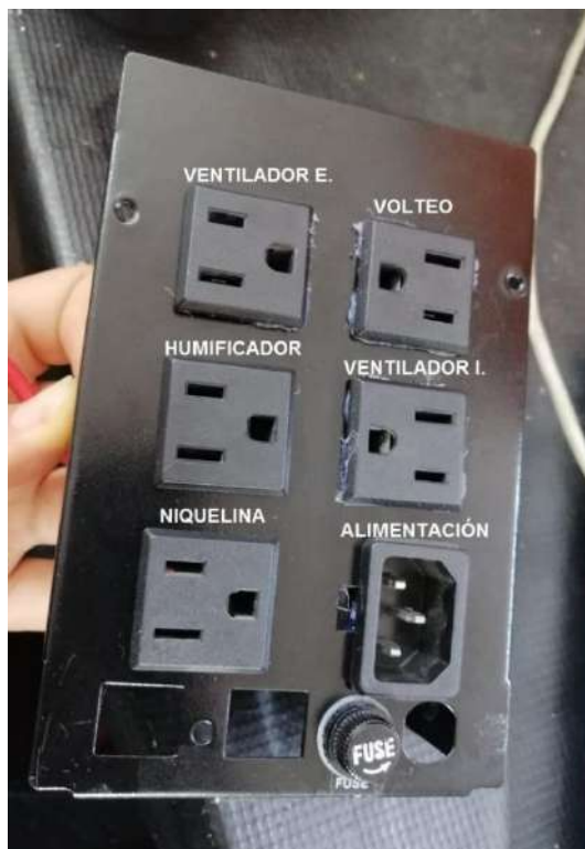
Figura 8-2: Parte posterior del UPS reciclado. Realizado por: Yerovi, Guillermo; 2020
