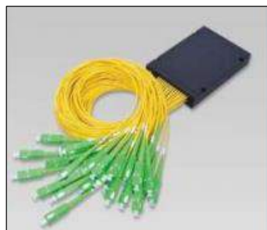
Figura 22-1: Splitter óptico 1x32
