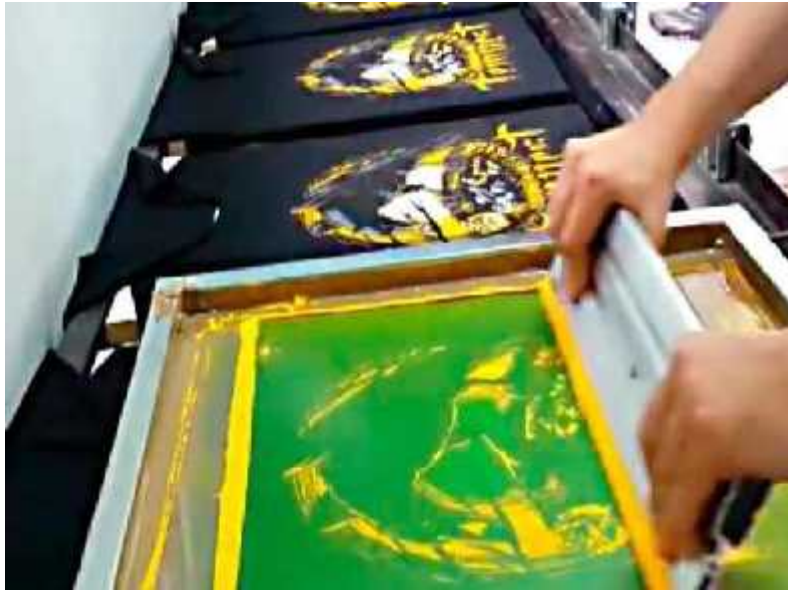
Figura 50-2: Proceso de descargar de tinta sobre textil
