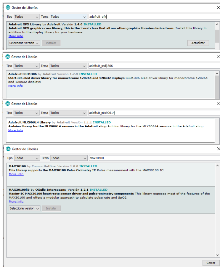
Figura 2: Instalando las librerías
