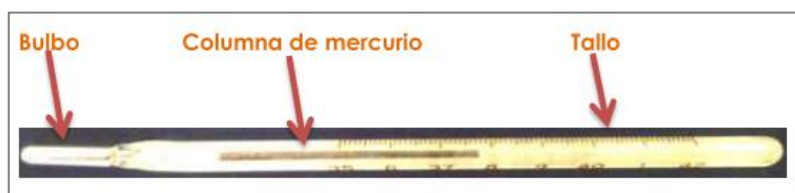
Figura 2-1: Partes del termómetro de vidrio
