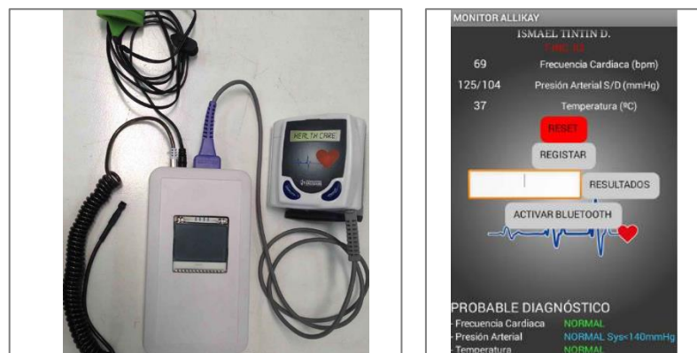
Figura 11-1: Prototipo monitor de signos vitales con métodos no invasivos
