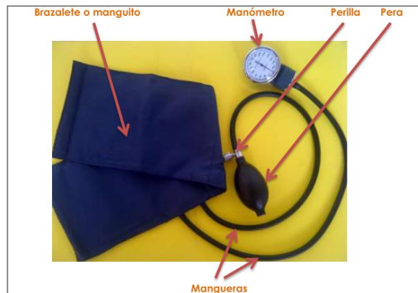
Figura 7-1: Partes de Tensiómetro anerode
