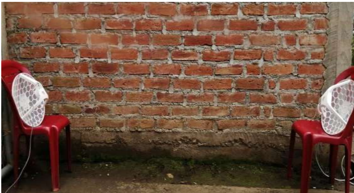
Figura 32-3: Antenas Mikrotik LHG 5 utilizadas en el enlace Cerro San Francisco – Nodo Quimiag
