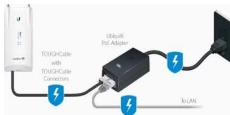
Figura 38-2: Esquema de conexión a través de Power over Ethernet (PoE)
