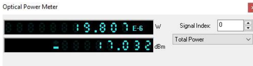
Figura 23-4. Potencia que llega a la ONT-Downstream Realizado por: Sarmiento, Jameson, 2021
