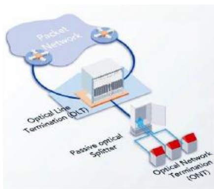
Figura 16-2. Diagrama de una Red Óptica Pasiva
