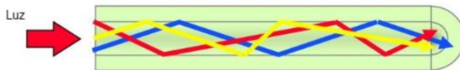
Figura 3-2. Fibra Óptica Multimodo (SM)
