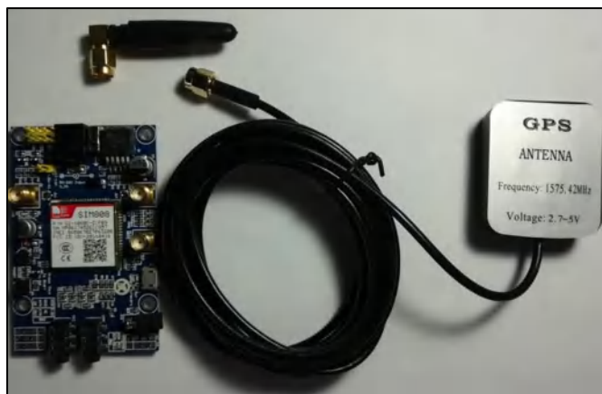
Figura 8-2. Módulo GSM SIM808 con antenas
