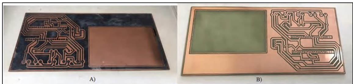
Figura 16-2. A) Revelado de la placa B) Placa después del ataque químico con cloruro férrico
