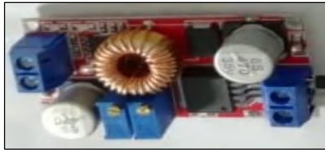
Figura 11-2. Convertidor Step-Down XL4015 con control CV/CC
