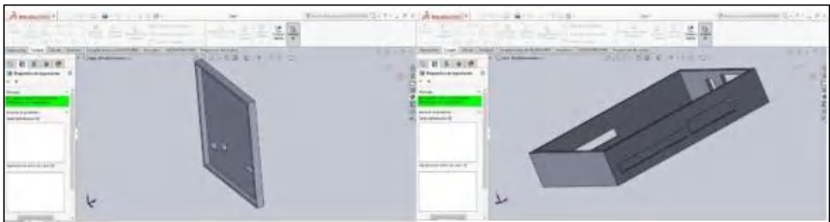
Figura 18-2. A) Diseño estructural de la tapa B) Diseño estructural de la base
