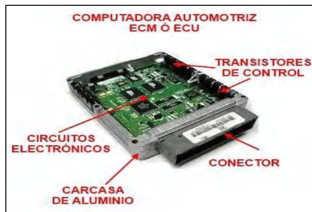
Figura 1-1: Principales partes de una computadora automotriz
