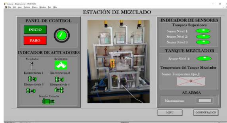
Figura 32-3: HMI local estación de mezclado del laboratorio.
