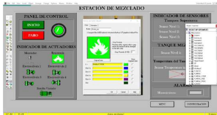
Figura 63-3: Programación del objeto modbus en lookout.
