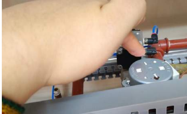
Figura 50-3: Puesta del motor en la estación de mezclado.
