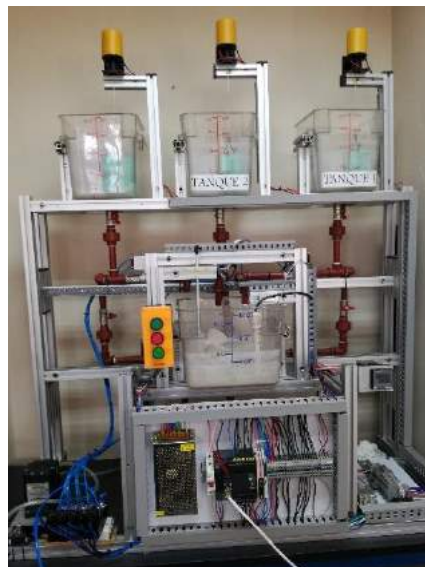
Figura 98-3: Estación de mezclado.
