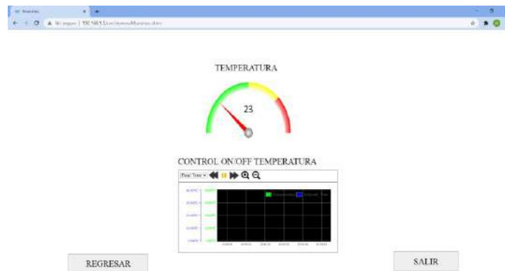
Figura 115-3: HMI visualización de estado de la temperatura.
