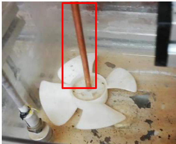
Figura 51-3: Acoplamiento del motor-mezclador.
