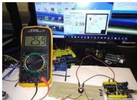
Figura 2-3: Medición de Corriente.
