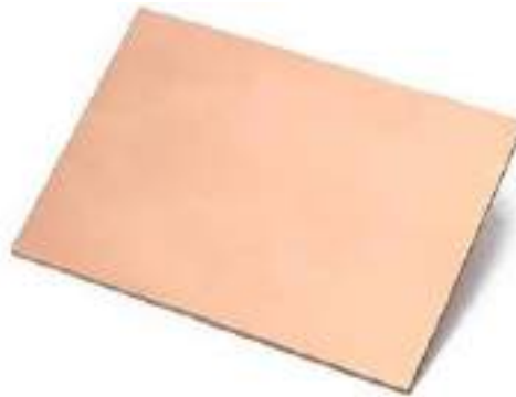
Figura 35-2: Lamina de sustrato FR4.
