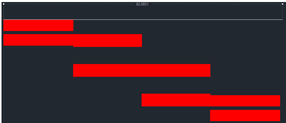
Figura C4-111: Pistas del filtro paso banda en AutoCad
