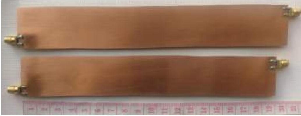
Figura 44-3: Filtro paso banda de 850MHz implementado. (a) Vista superior (b) Vista posterior
