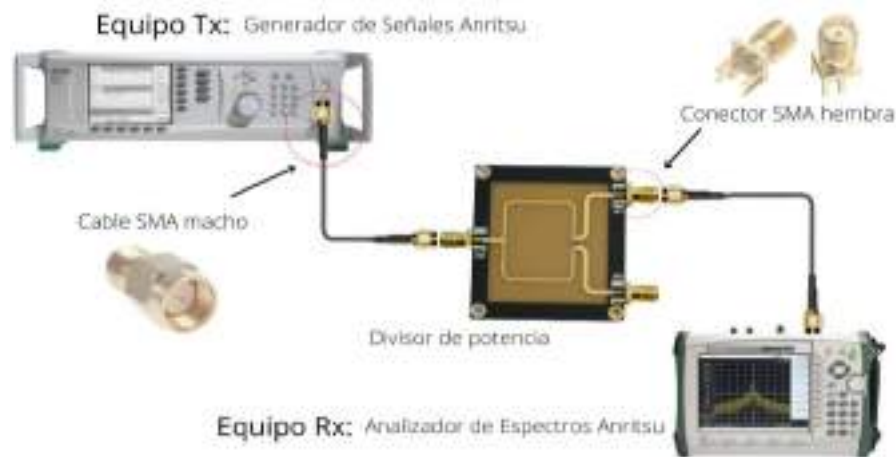
Figura 36-2: Esquema de medición de dispositivos microstrip con conectores SMA
