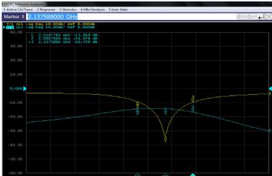
Figura 22-4: Resultados de los parámetros S del Filtro paso banda AWS 1700/2100MHz (downlink) medidos en el Analizador de Redes
