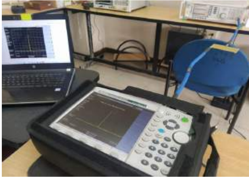
Figura 53-3: Medición del espectro del divisor Wilkinson de 700MHz
