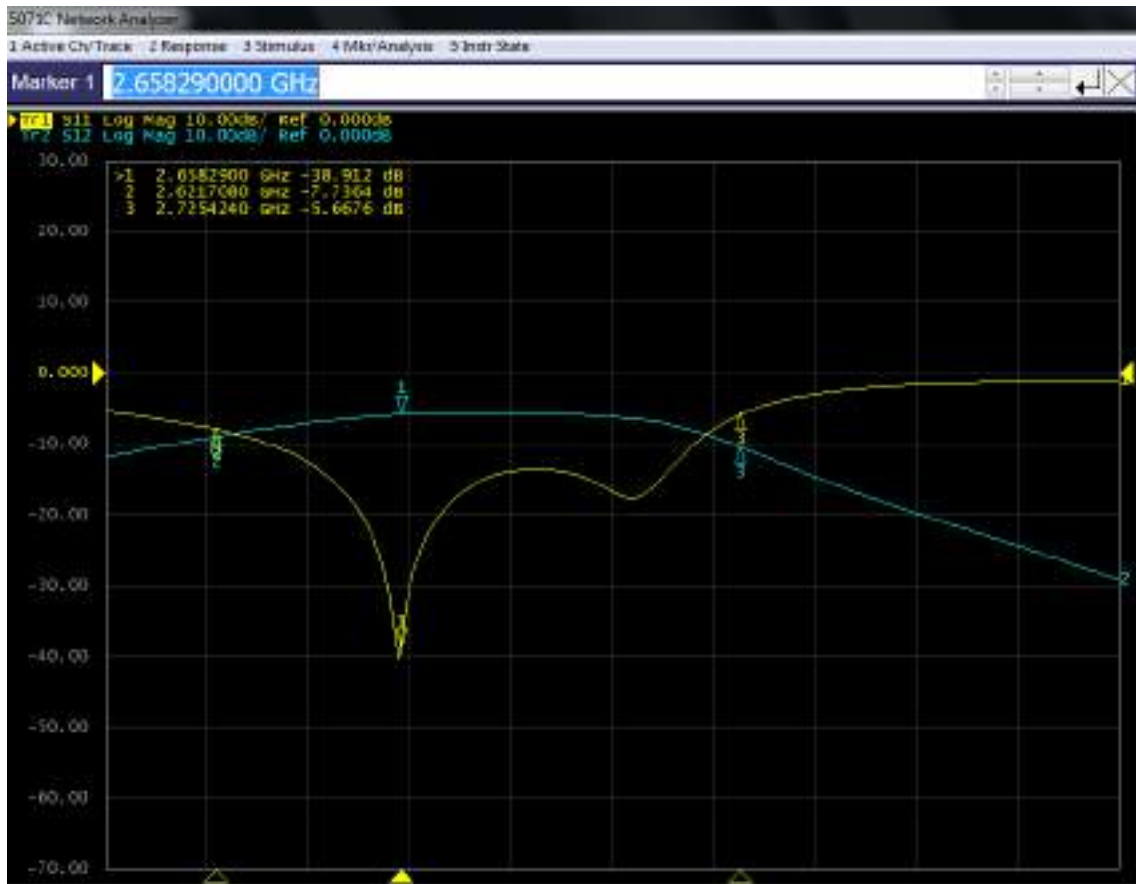
Figura 30-4: Resultados de los parámetros S del Filtro paso banda de 2.5GHz (downlink) medidos en el Analizador de Redes
