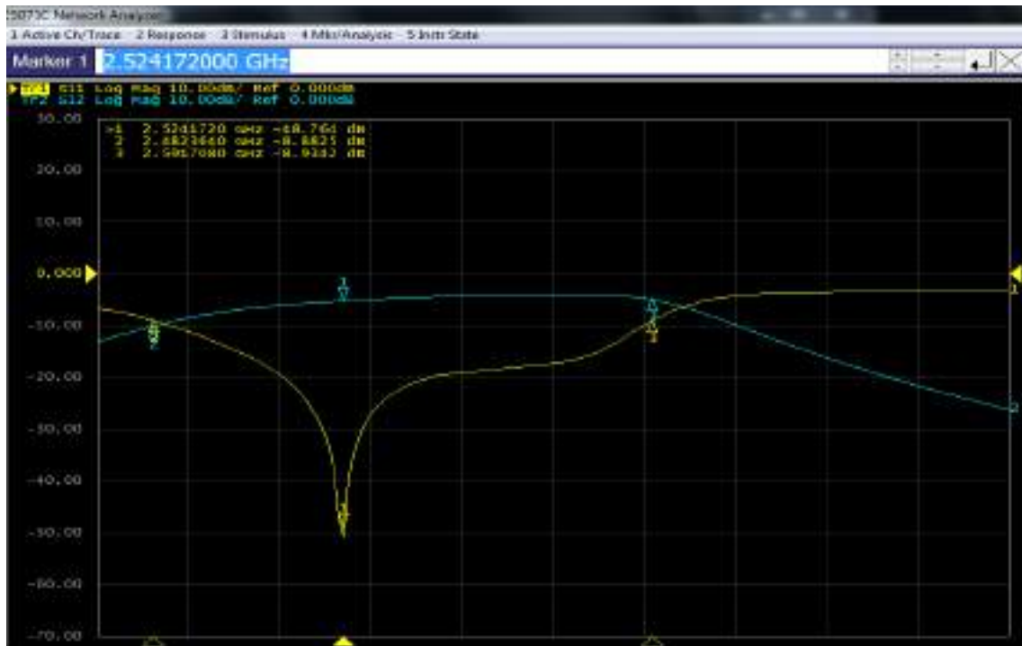
Figura 28-4: Resultados de los parámetros S del Filtro paso banda de 2.5GHz (uplink) medidos en el Analizador de Redes
