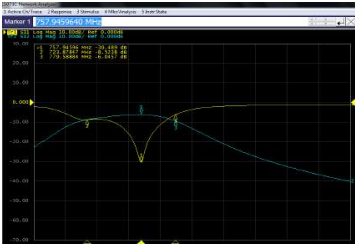
Figura 10-4: Resultados de los parámetros S del Filtro paso banda de 700MHz (downlink) medidos en el Analizador de Redes
