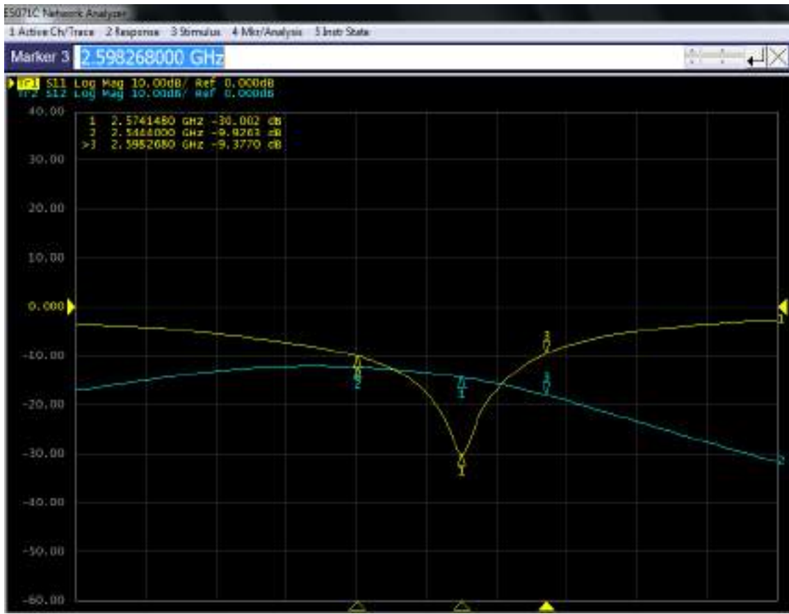
Figura 26-4: Resultados de los parámetros S del Filtro paso banda de 2.5GHz (downlink) medidos en el Analizador de Redes
