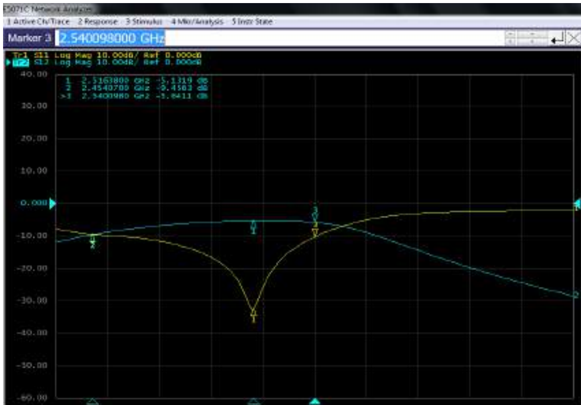
Figura 24-4: Resultados de los parámetros S del Filtro paso banda de 2.5GHz (uplink) medidos en el Analizador de Redes
