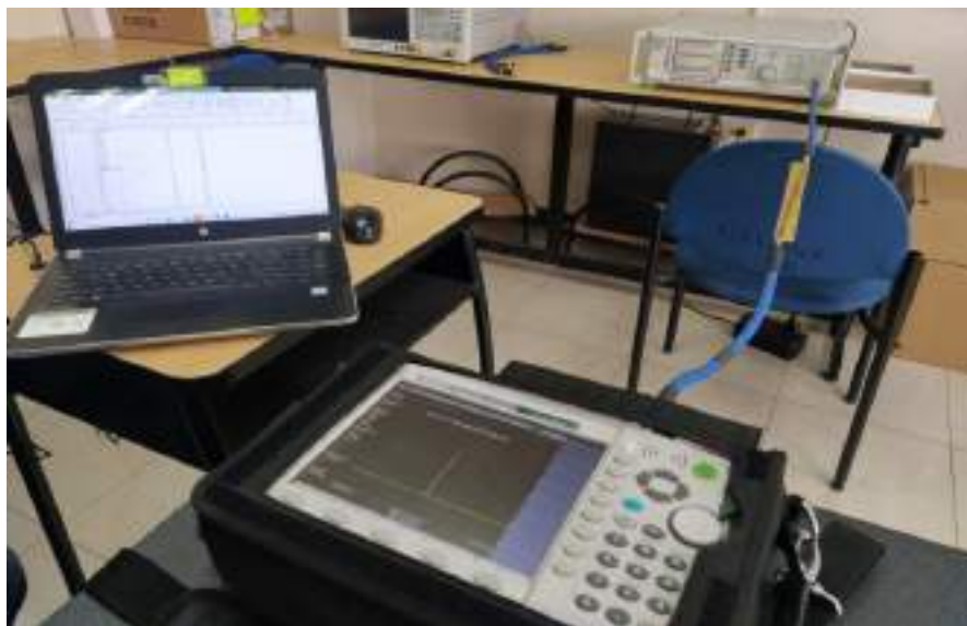
Figura 52-3. Medición del espectro del filtro paso banda de 700MHz (downlink)
