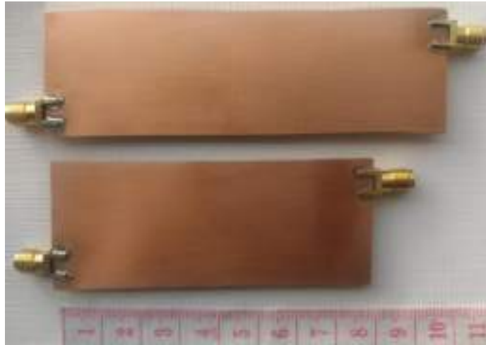
Figura 46-3: Filtro paso banda AWS 1700/2100MHz implementado. (a) Vista superior (b) Vista posterior
