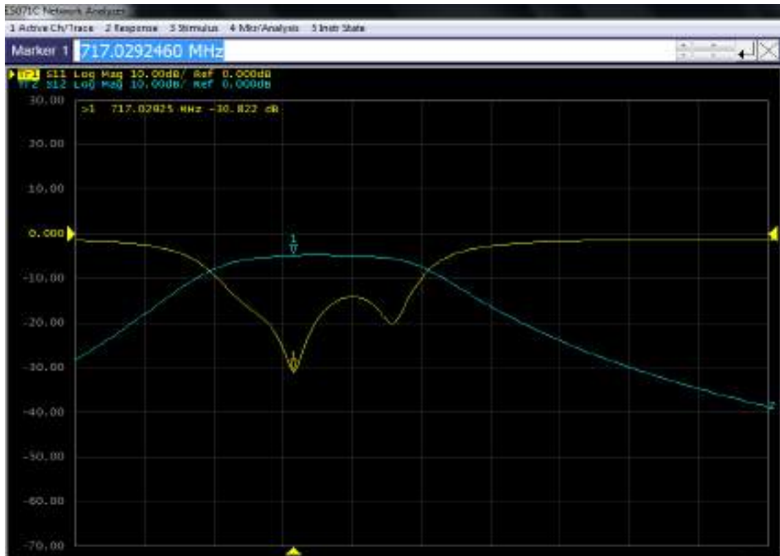
Figura 8-4: Resultados de los parámetros S del Filtro paso banda de 700MHz (uplink) medidos en el Analizador de Redes
