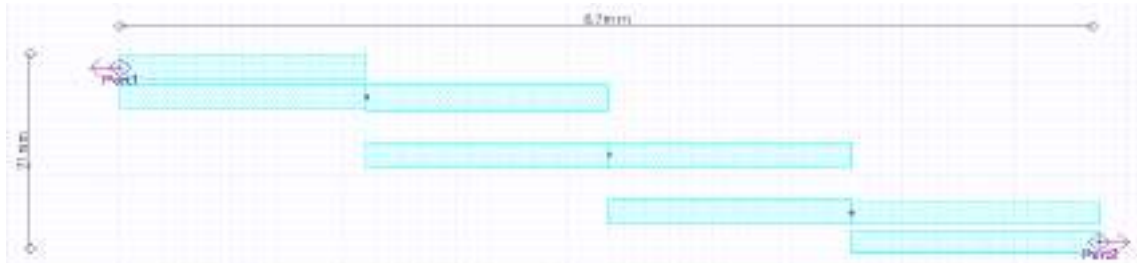
Figura 21-3: Filtro paso banda (uplink) en la banda de 1900MHz
