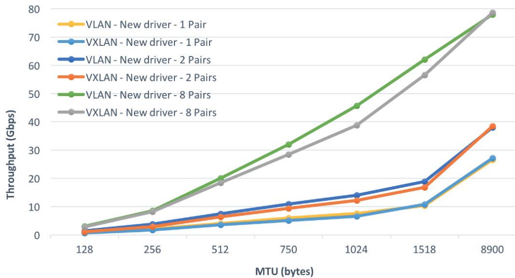
Figura 26-1: Rendimiento de VLAN frente a VxLAN después de utilizar NIC's de próxima generación
