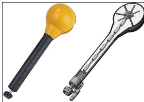
Figura 5-2: Antena de medición de 3 ejes
