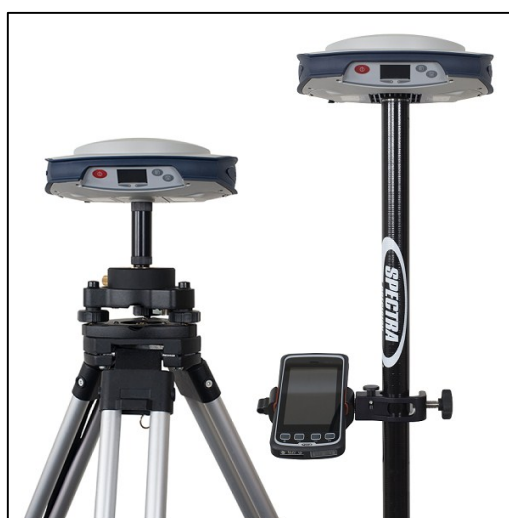
Figura 2-2: GPS Mobile Mapper 50
