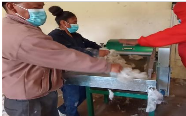
Ilustración 2-6: Proceso de escarmenado en maquinaria
