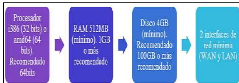
Figura 2-2: Requerimientos de hardware OPNSENSE
