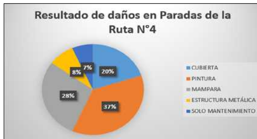
Figura 32-3: Resultado de daños en paradas ruta N°4
