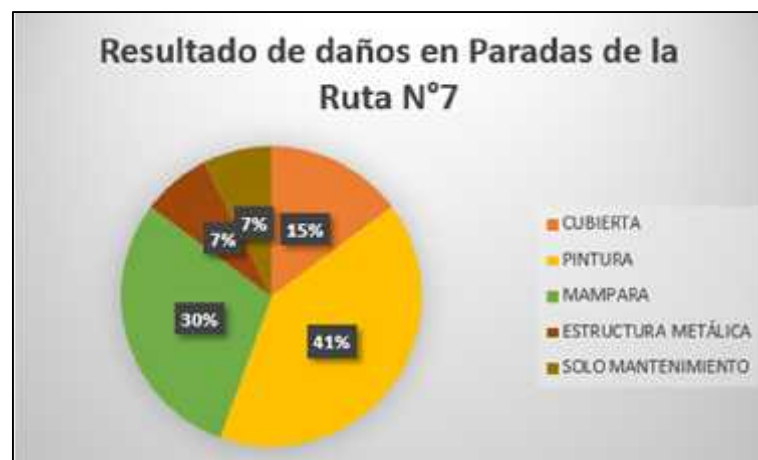
Figura 59-3: Resultado de daños en paradas ruta N° 7
