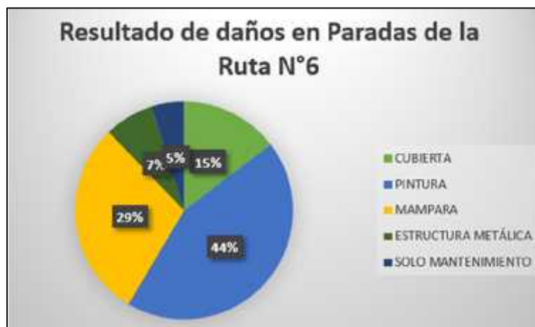
Figura 50-3: Resultado de daños en paradas ruta N°6
