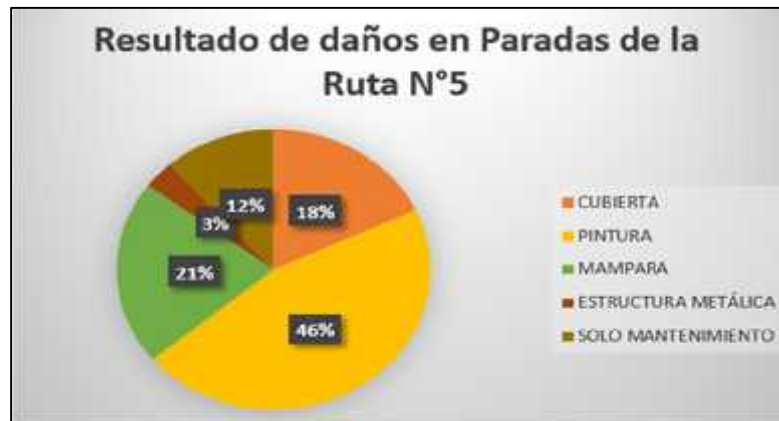
Figura 41-3: Resultado de daños en paradas ruta N°5
