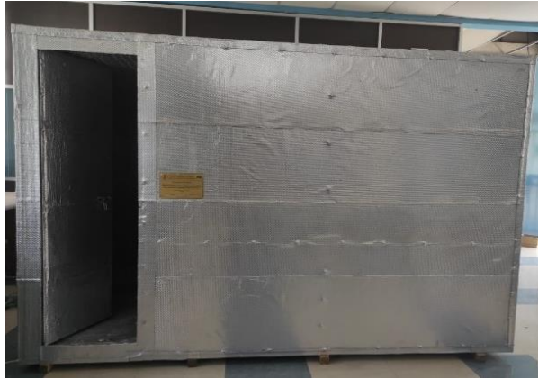
Figura 7-3. Cámara anecoica terminada
