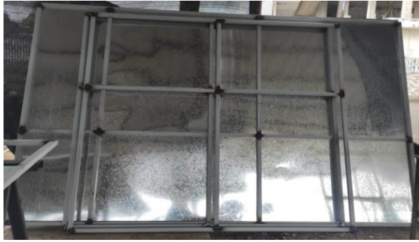
Figura 2-3. Pared de tubos cuadrados con tol galvanizado
