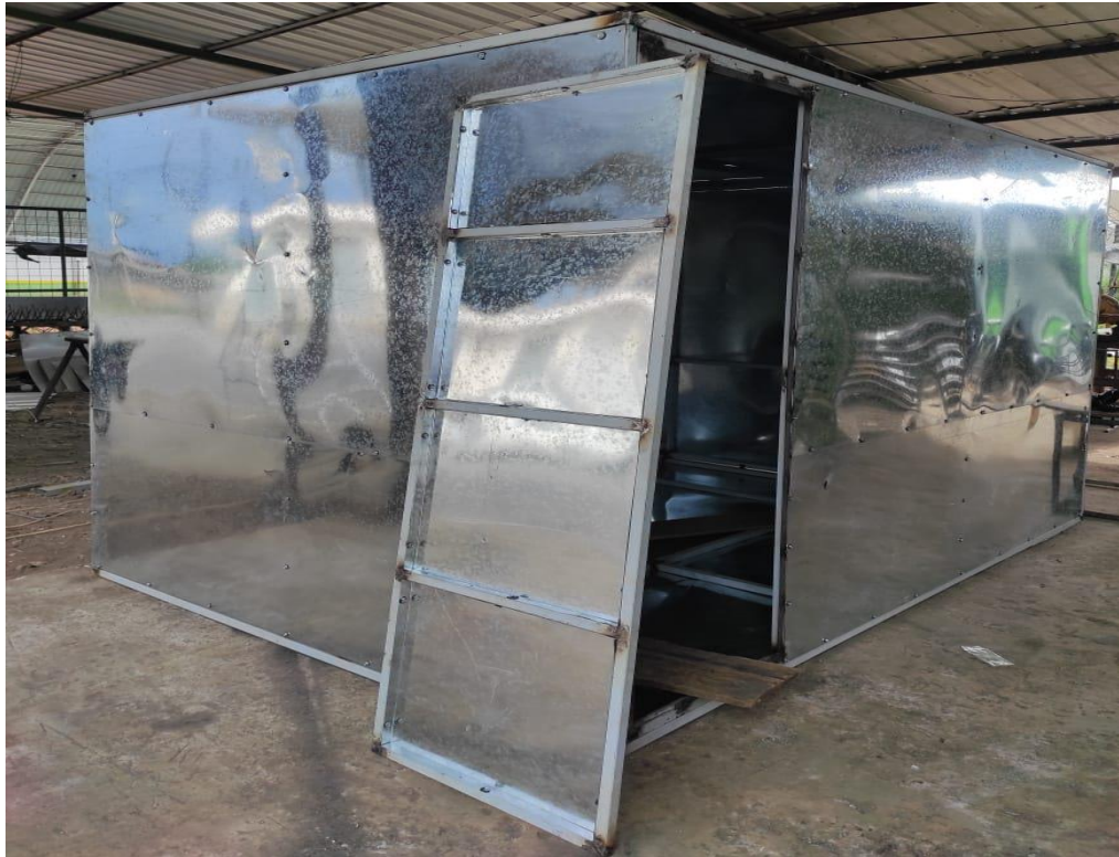
Cobertura total de tol galvanizado en la estructura rectangular.
