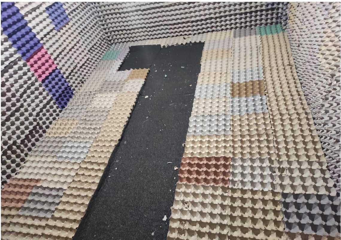
Pegado de cubetas de huevos y colocación de la alfombra en el piso de la caja
