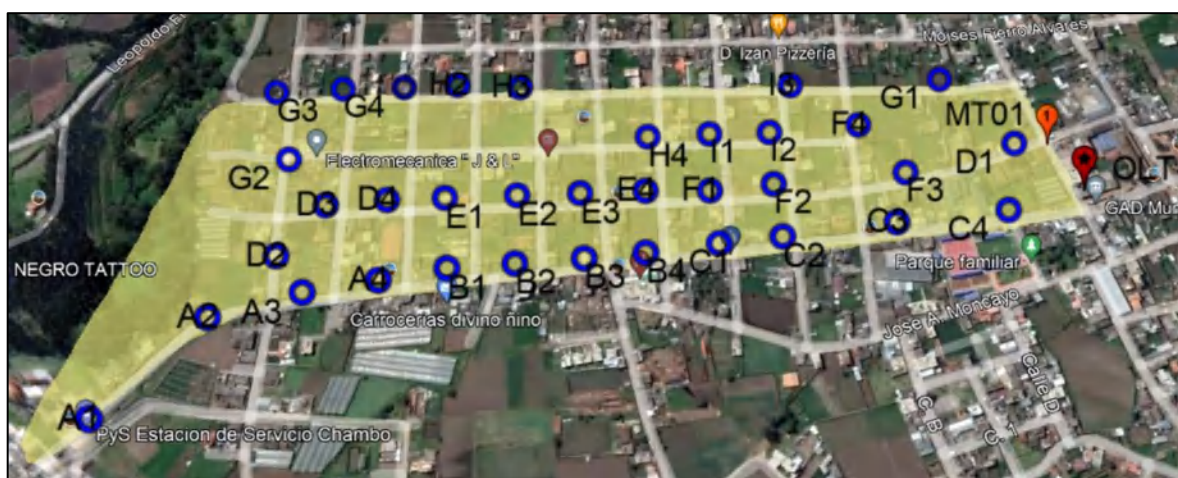
Figura 20-2. Cajas de distribución ópticas para la MT01
