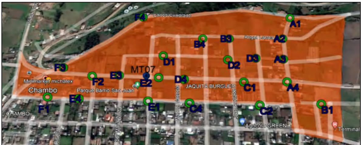
Figura 32-2. Cajas de distribución ópticas para la MT07
