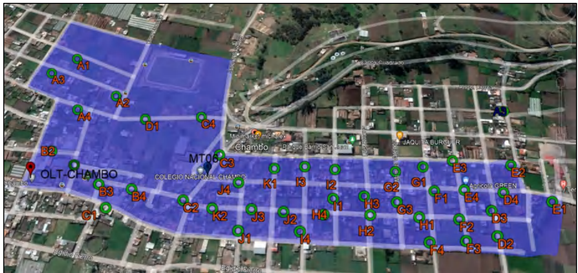
Figura 30-2. Cajas de distribución ópticas para la MT06
