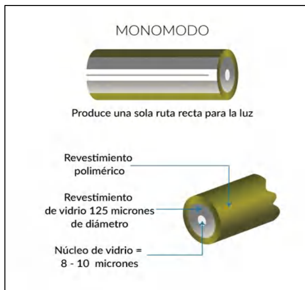
Figura 3-1. Estructura de la fibra monomodo
