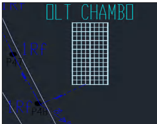
Figura 12-2. Cable Feeder desde la OLT al poste P48
