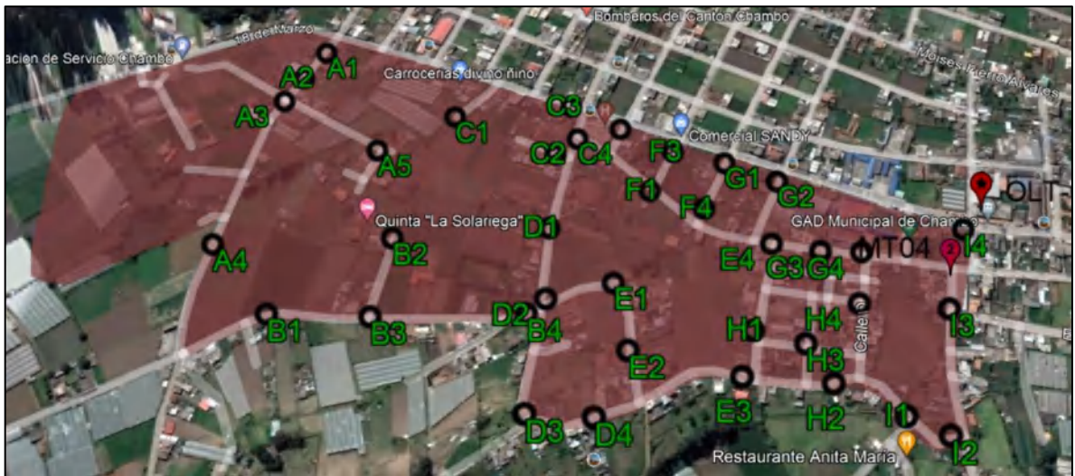
Figura 26-2. Cajas de distribución ópticas para la MT04
