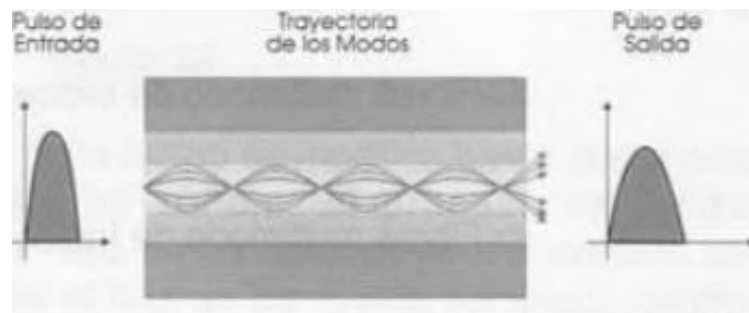
Figura 10-2. Fibras multimodo con índice gradual
