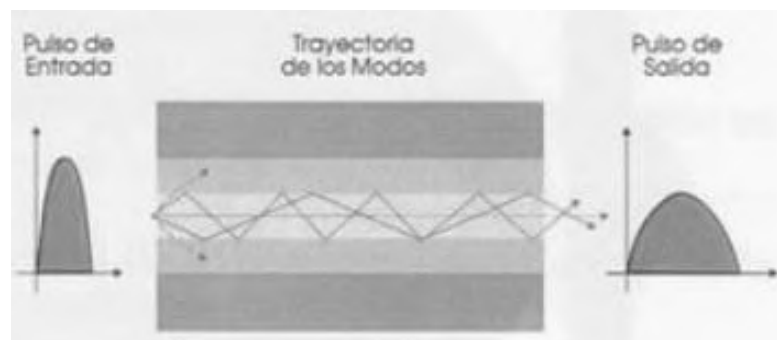
Figura 9-2. Fibras multimodo con índice en escalón
