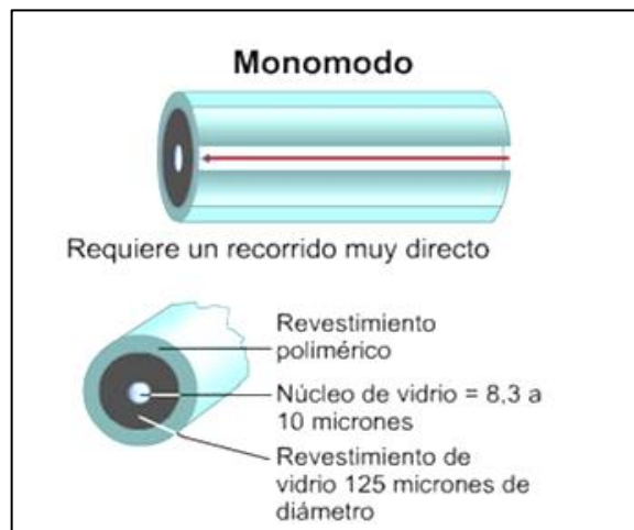
Figura 5-1: Fibra monomodo
