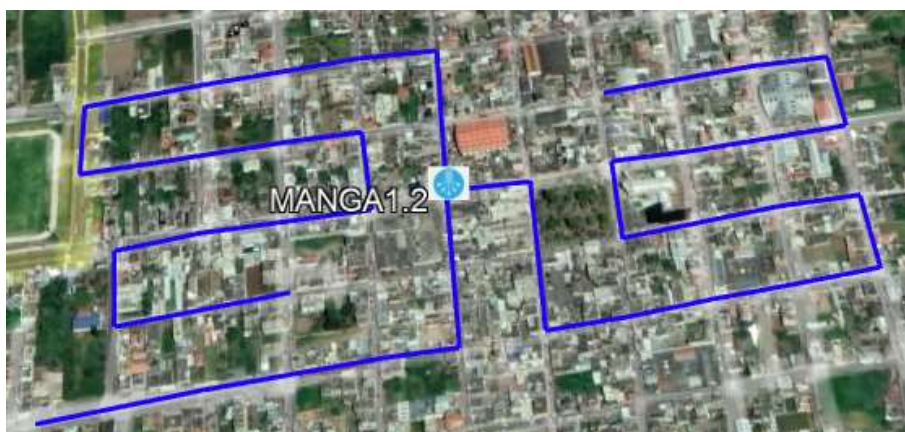
Figura 12-3: Tramos de fibra de la manga 1.2
