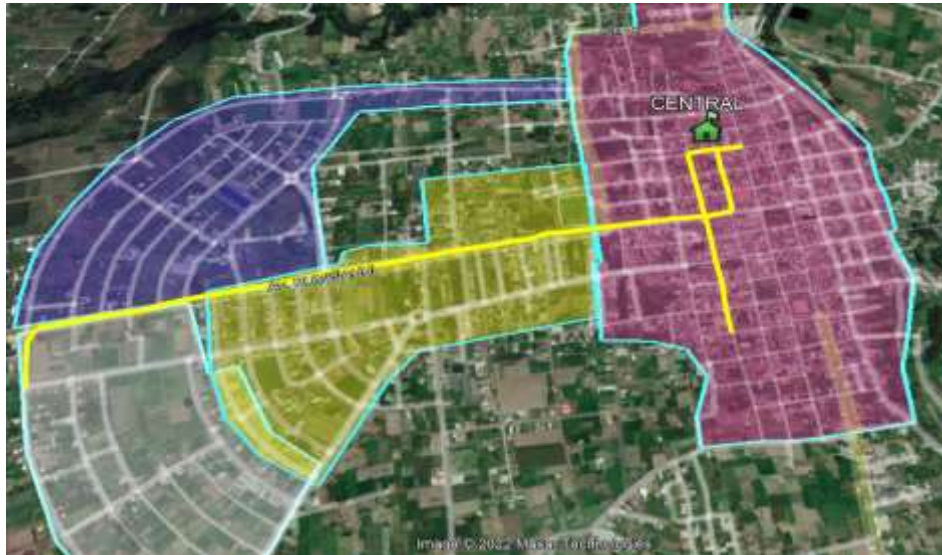
Figura 8-3: Tramo de fibra para red feeder.
