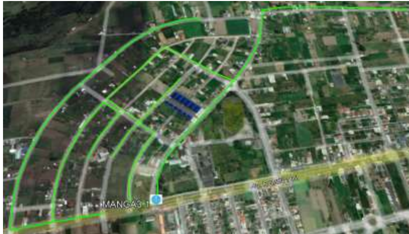
Figura 16-3: Tramos de fibra de la manga 3.1
