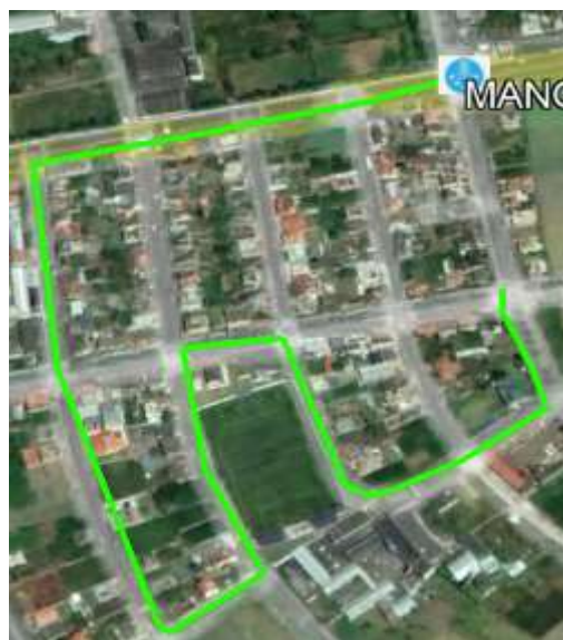
Figura 15-3: Tramos de fibra de la manga 2.2
