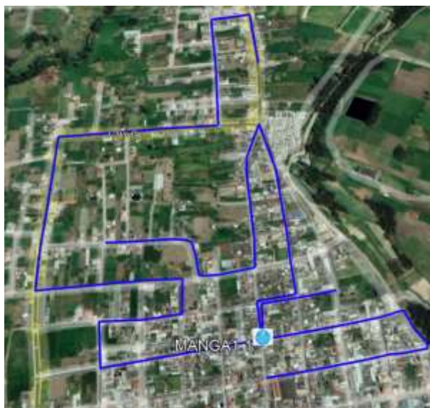
Figura 11-3: Tramos de fibra de la manga 1.1
