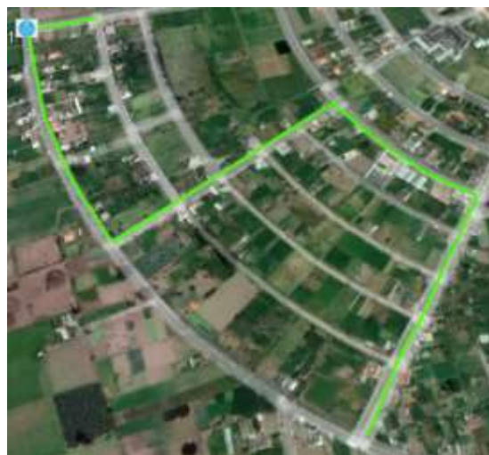
Figura 17-3: Tramos de fibra de la manga 4.1
