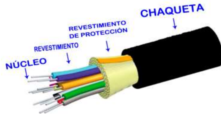
Figura 3-2: partes de la fibra óptica
