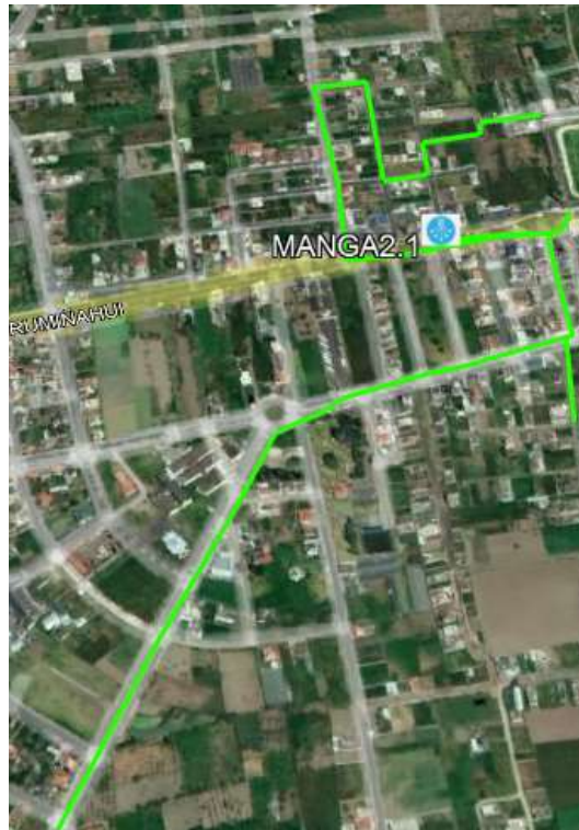
Figura 14-3: Tramos de fibra de la manga 2.1
