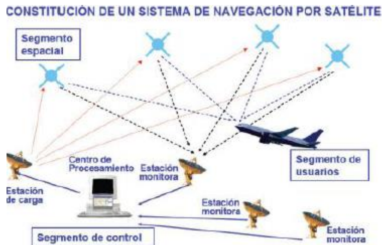
Figura 1-1: Funcionamiento de un GNSS
