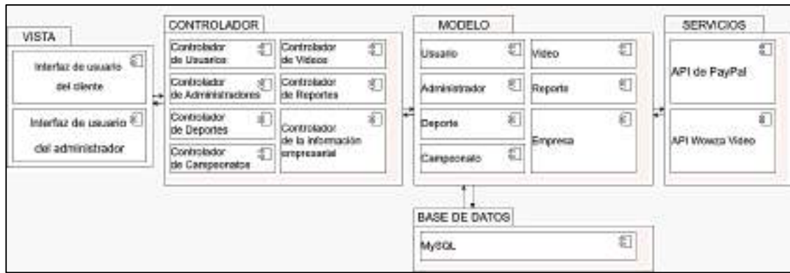
Ilustración 9-3: Diagrama de componentes de la arquitectura de software para el sistema web de live streaming.
