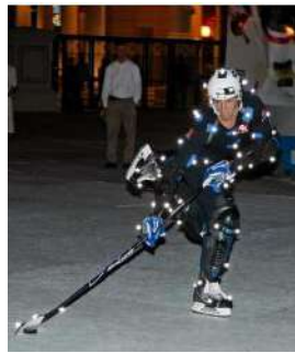
Ilustración 8-2: Captura de movimiento mediante sistema de marcadores pasivos
