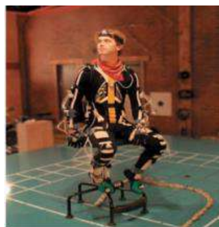
Ilustración 5-2: Sistema de seguimiento corporal Electromagnético.
