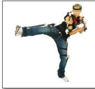
Ilustración 4-2: Sistema de seguimiento corporal Electromecánico.
