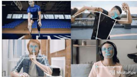
Ilustración 1-2: Ejemplos de estimación de pose con MediaPipe Fuente: MediaPipe, 2020
