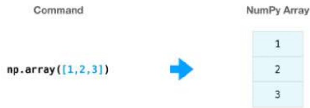
Ilustración 16-2: Comando NumPy para generar un arreglo y representación del NumPy Array
