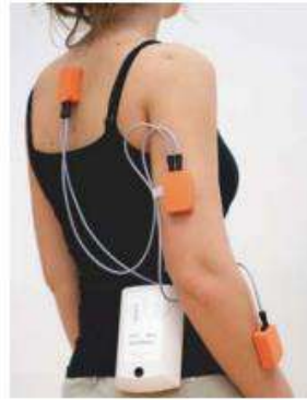
Ilustración 6-2: Sistema de seguimiento corporal Inercial. Fuente: Unzueta, 2015, p. 6
