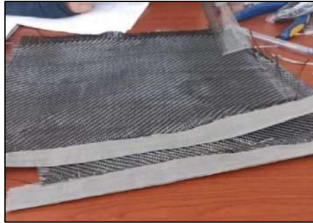
Figura 23-3 Fibra de carbono y malla de acero (ánodo y cátodo)
