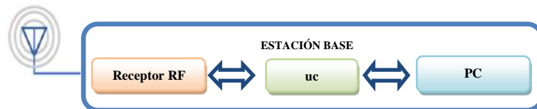
Figura 3-3 Diagrama de bloques de la estación base
