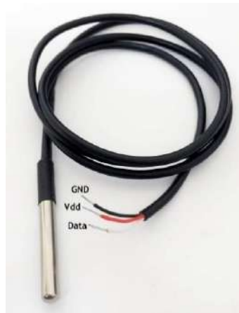
Figura 7-3 Sensor de temperatura ds18b20
