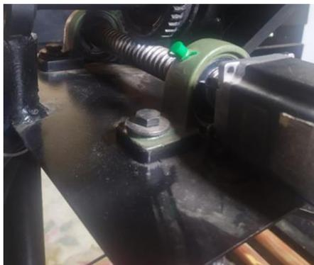
**Ilustración 3-17:** Soporte para el motor primario.
