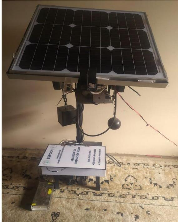
**Ilustración 4-1:** Seguidor fotovoltaico
