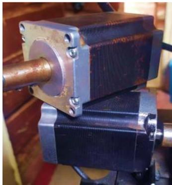
**Ilustración 3-20:** Motores Nema 23
