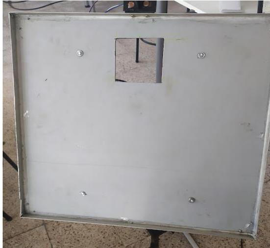
**Ilustración 3-11:** Construcción de la base para el panel solar
