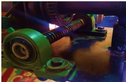
**Ilustración 3-22:** Sistema tornillo sin fin – piñón
