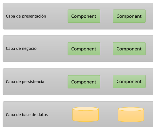
Ilustración 1-2: Esquema de la arquitectura en N-Capas
