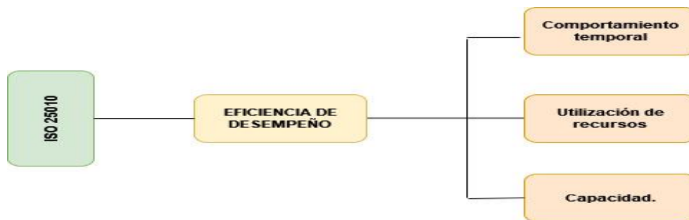
Ilustración 6-2: Diagrama de las Subcaracterísticas de la eficiencia según ISO/IEC 25010
